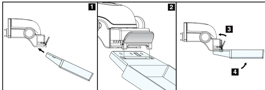
Abbildung 59: So installieren Sie eine Kompressionsplatte
