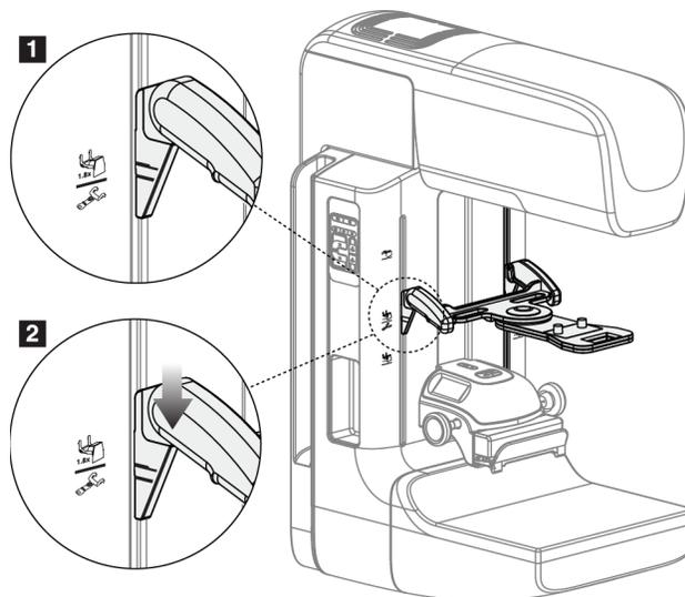
Abbildung 63: Installation der Lokalisierungs-Fadenkreuzvorrichtung
