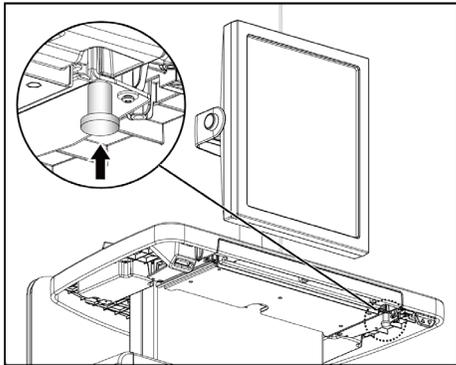
Abbildung 97: Tastaturfach-Verriegelungsknopf
