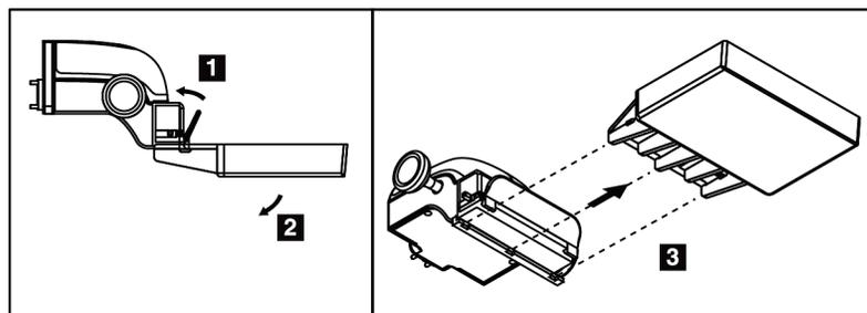
Abbildung 60: So entfernen Sie eine Kompressionsplatte
