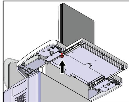
Abbildung 98: Tastaturfach-Verriegelungsknopf
