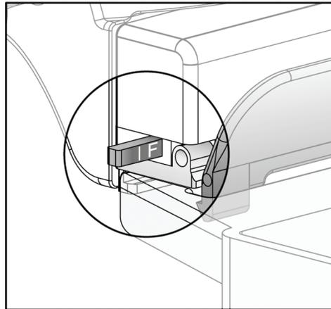
Abbildung 61: Der Schieberegler des Kompressionsmodus FAST
