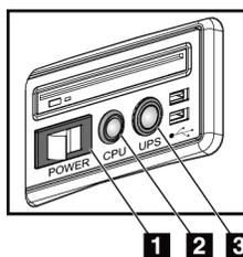
*Abbildung 15: Netztasten an der Universal-Akquisitions-Workstation*
