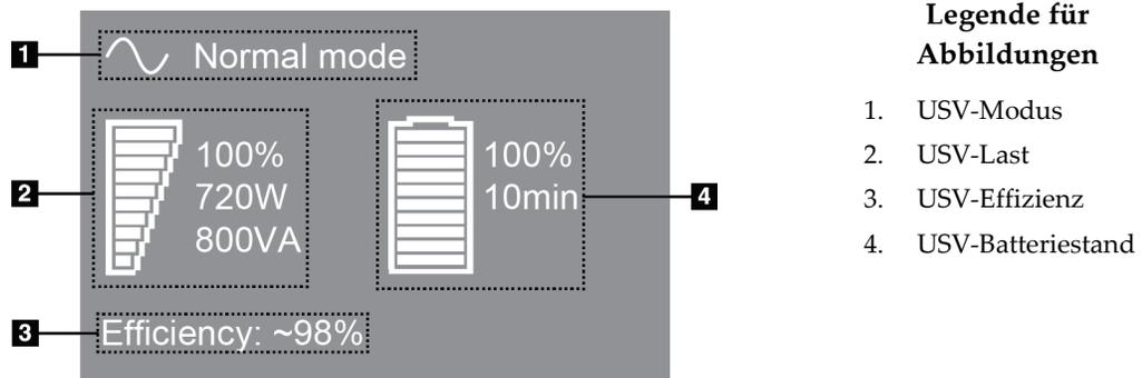
Abbildung 96: USV LCD-Display
