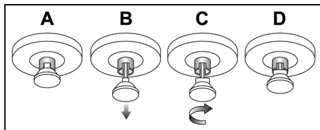
Abbildung 101: Lösen der Verriegelung des Fachs von Verriegelt (A) zu Entriegelt (D)
