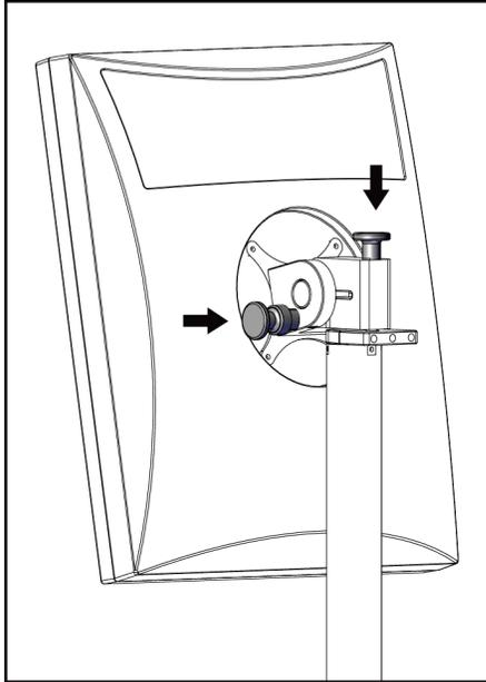
Abbildung 100: Knöpfe zur Verriegelung des drehbaren Bildanzeigemonitors an der mobilen Universal-Akquisition-Workstation
