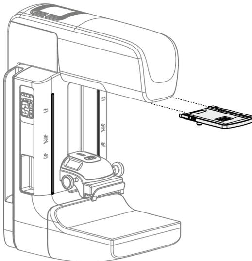
Abbildung 64: So installieren und entfernen Sie die Vergrößerungs-Fadenkreuzvorrichtung
