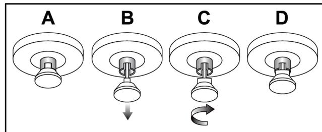
Abbildung 99: Lösen der Verriegelung des Fachs von Verriegelt (A) zu Entriegelt (D)
