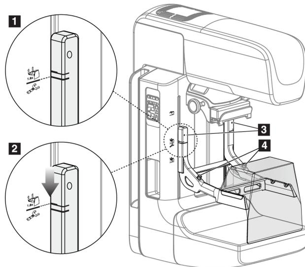
Abbildung 62: Installation des Vergrößerungsstativs
