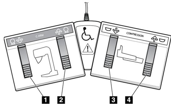
Abbildung 12: Zweifunktions-Fußschalter
