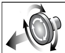
*Abbildung 14: Die Not-Aus-Schalter durch Drehen zurücksetzen*
