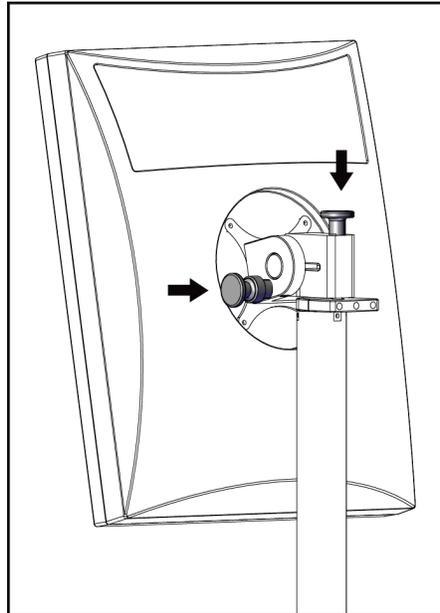
Abbildung 102: Knöpfe zur Verriegelung des drehbaren Bildanzeigemonitors an der mobilen Universal-Akquisition-Workstation
