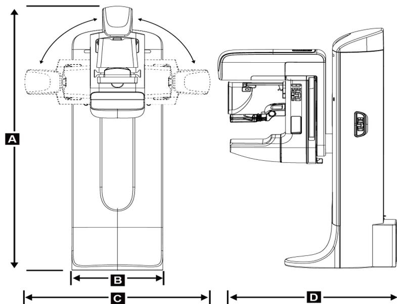
Abbildung 93: Abmessungen Säulenstativ (Gantry mit C-Bogen)
