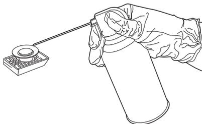
**Figura 3-21 Use o spray de congelação para arrefecer o bloco de células**
