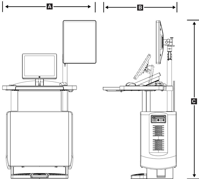
Figura 103: Medidas da estação de trabalho Acquisition universal móvel
