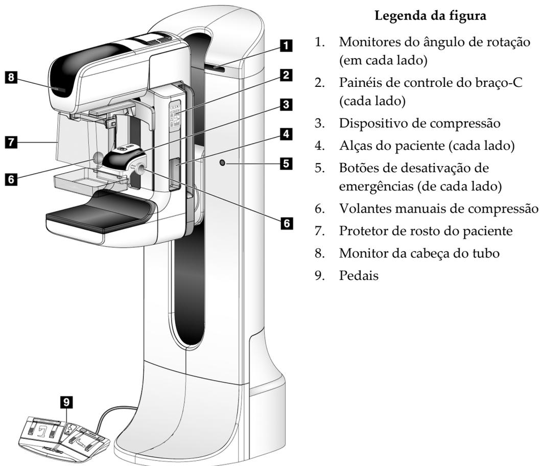
*Figura 7: Controles e indicadores do tubo de suporte*
