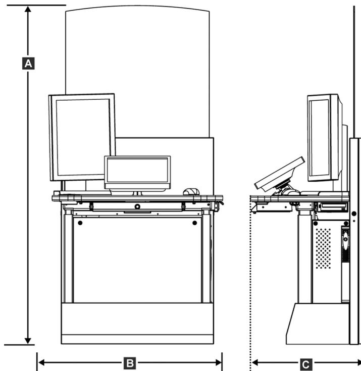
Figura 102: Medidas da Estação de trabalho Acquisition Padrão
