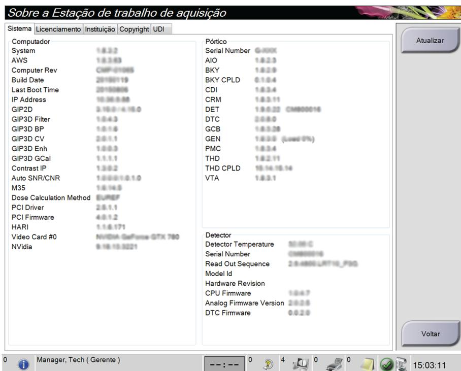
Figura 76: Guia Sistema da tela Sobre (Estação de trabalho Acquisition)
