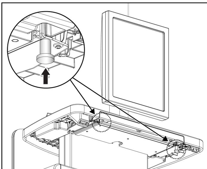
Abbildung 100: Verriegelungsknopf des Tastaturfachs
