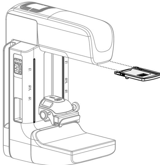
Abbildung 67: So installieren und entfernen Sie die Vergrößerungs-Fadenkreuzvorrichtung
