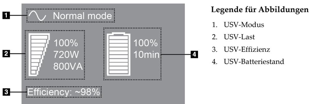
Abbildung 99: USV LCD-Display
