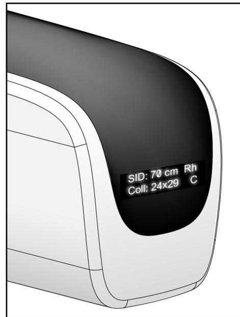
Abbildung 7: Strahlerkopf-Display
