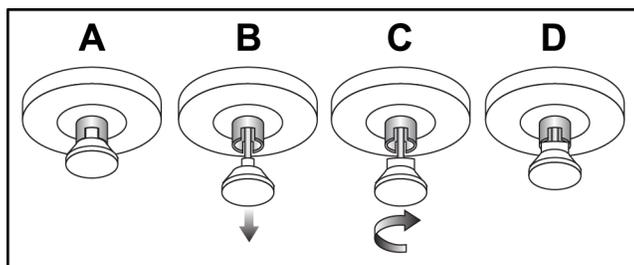
Abbildung 101: Lösen der Verriegelung des Fachs von
