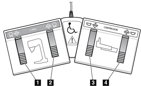
Abbildung 12: Zweifunktions-Fußschalter
