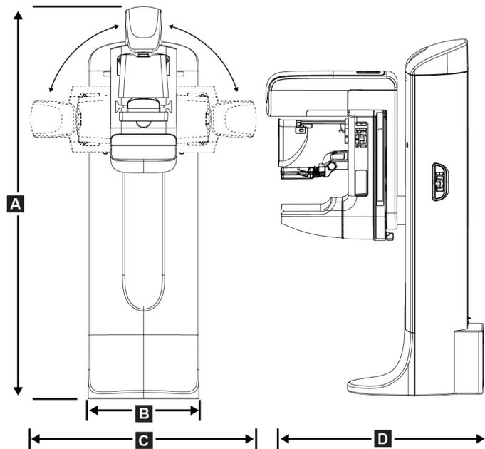
Figura 96: Medidas do tubo suporte (Pórtico com braço-C)
