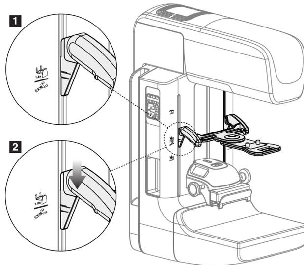
Figura 66: Instalação do dispositivo do retículo de localização
