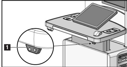
Figura 79: Painel de controle de ajuste de altura
