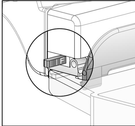
Figura 64: Controle deslizante do modo de compressão FAST
