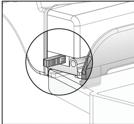
*Figure 73 : Bouton coulissant du mode de compression FAST*
