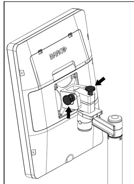
*Figure 119 : Boutons de verrouillage de l'écran pivotant sur la station d'acquisition universelle mobile (série II)*
