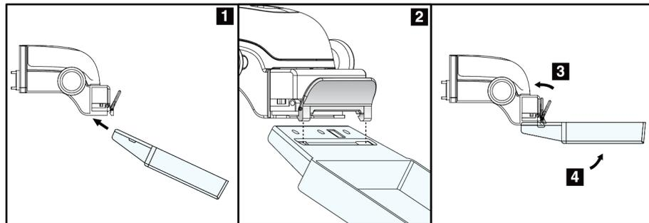
Figure 71 : Pour installer une pelote de compression
