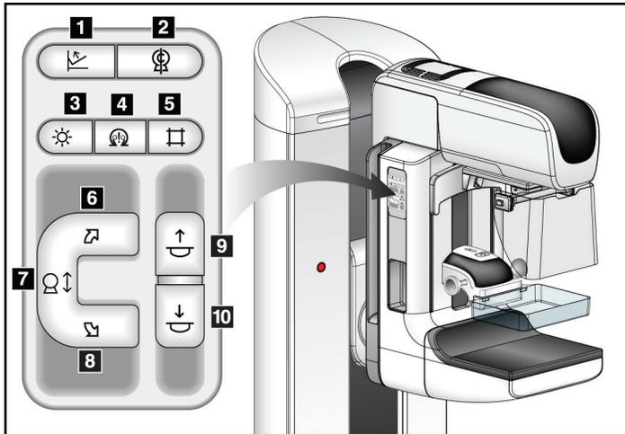
Figure 23 : Panneau de commande du bras en C
