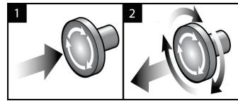
図4: 緊急停止スイッチの機能
