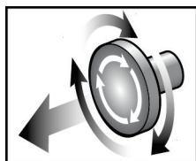
図16: 回転させて緊急停止
