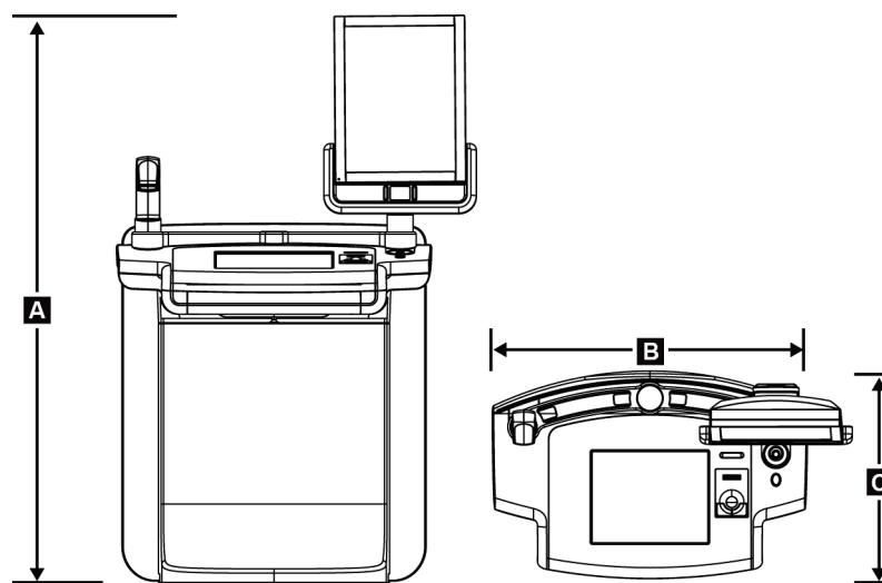
図109: 車載用プレミアム画像取り込みワークステーションの寸法
