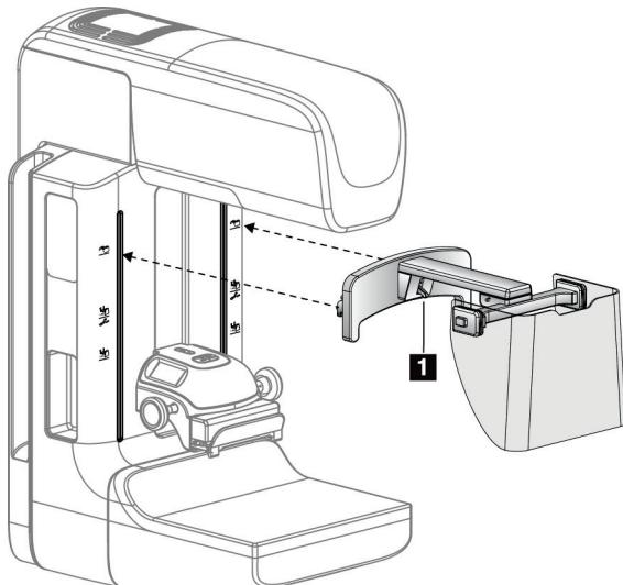
図67: フェイスシールドの取り付け
