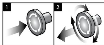
図24: 緊急停止スイッチの機能
