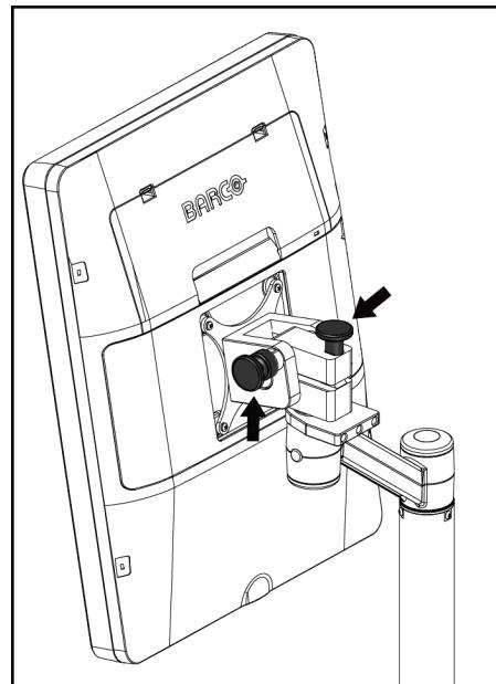
図118: 車載用汎用型画像取り込みワークステーション (シリーズII) の旋回式表示モニターのロックノブ
