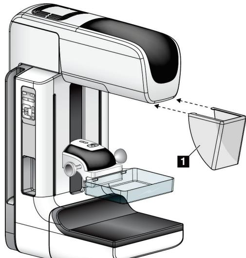
図69: 2D フェイスシールドを取り付ける方法
