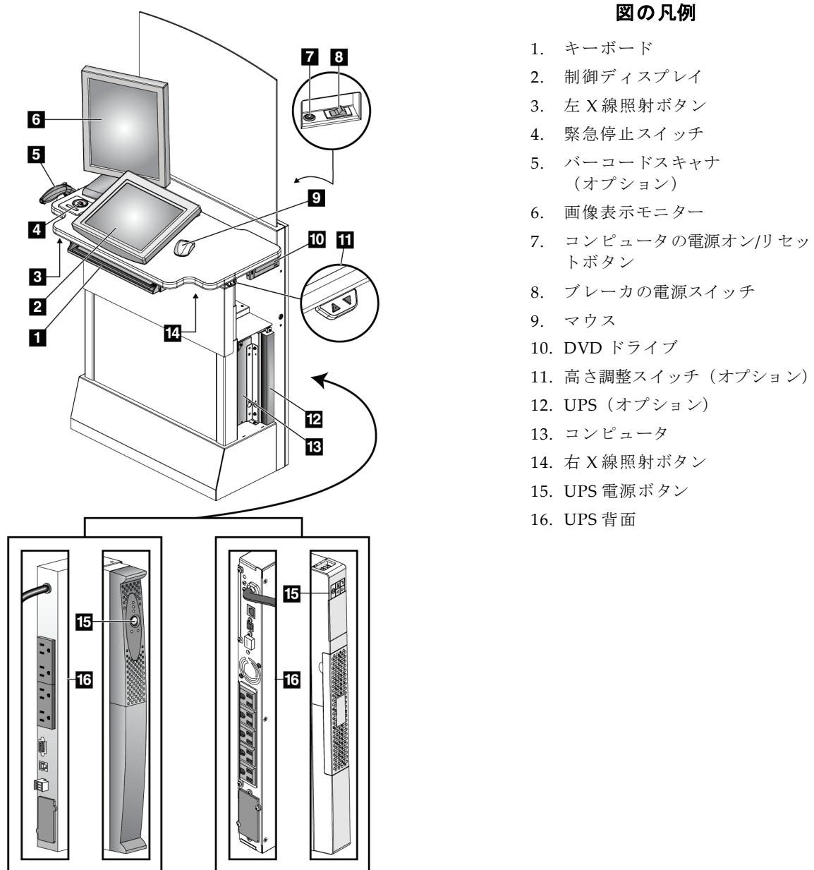
図15: 標準画像と取り込みワークステーションの制御とディスプレイ
