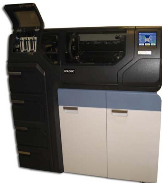
Figura 2-1 Un procesador ThinPrep 5000 normal con AutoLoader
