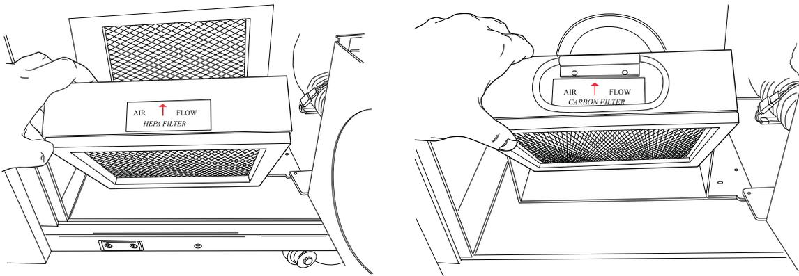
Figura 8-21 Retirada de los filtros HEPA y de carbono
