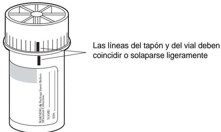
Figura 3-1 Alineación del tapón del vial
