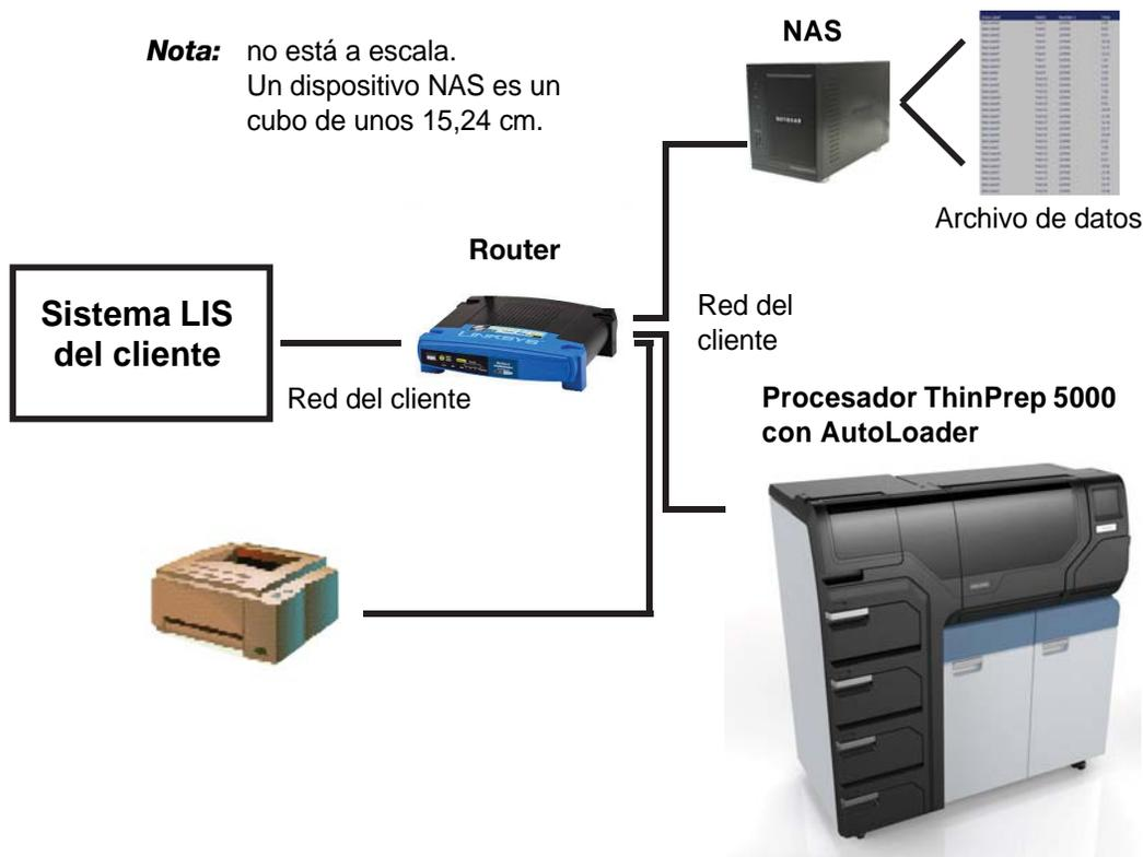
Figura 2-2 Conexión esquemática de una red local (ejemplo)
