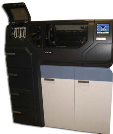
Figura 1-1 Un procesador ThinPrep 5000 con AutoLoader
