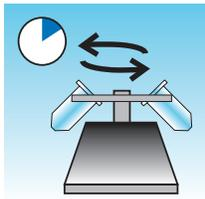
A finalidade deste procedimento consiste em concentrar o material celular de modo a separar o(s) componente(s) celular(s) do sobrenadante. Esta etapa é realizada com amostras recém-colhidas e após a adição de Solução CytoLyt®. Quando especificado no protocolo, execute a centrifugação das amostras a 600 vezes a gravidade normal (600 g) durante 10 minutos para forçar as células da solução a tomarem a forma de um pellet no fundo do tubo de centrífuga.
