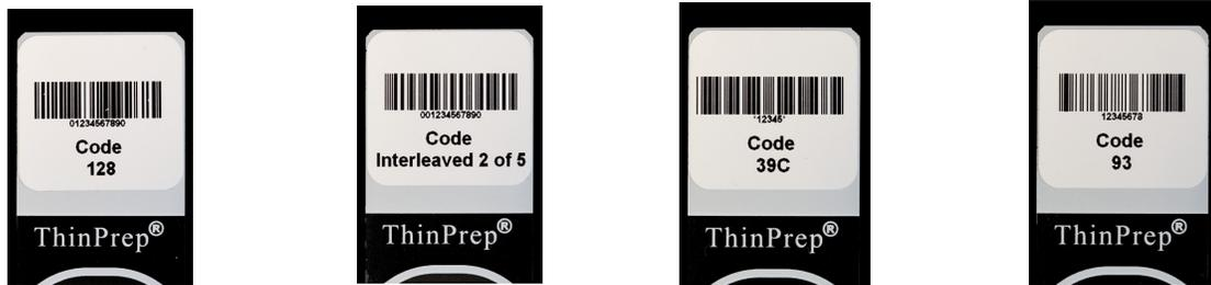
Figura 7-20 Exemplos de como os códigos de barras encaixam numa lâmina ThinPrep
