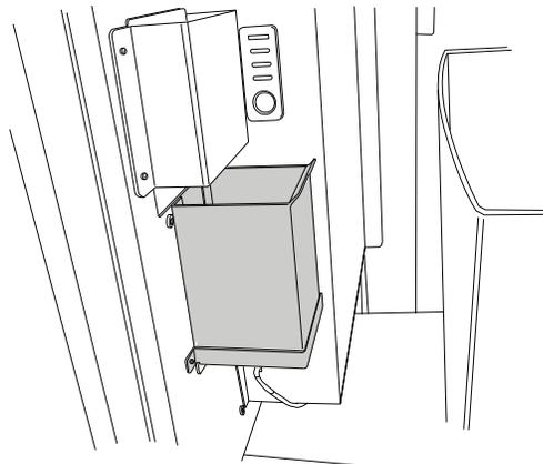
Figura 8-7 Recipiente de lâminas descartadas
