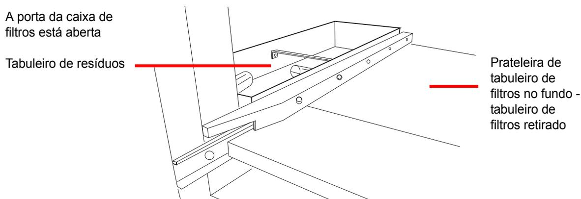
Figura 9-8 Tabuleiro de resíduos da haste do elevador do braço robótico
