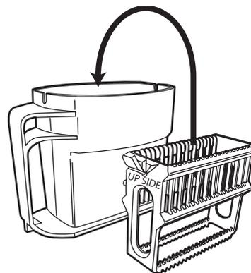
Banhos fixadores - oriente o suporte de coloração de forma a que as palavras "UP SIDE" (ESTE LADO PARA CIMA) gravadas em relevo fiquem viradas para a pega da tina do banho. Pressione o suporte de coloração totalmente até sentir o suporte a encaixar no lugar. O suporte tem de ficar completamente assente.
