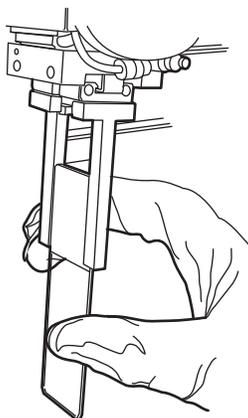
Uma lâmina deixada no trajeto de processamento poderá estar na pinça de lâminas ou nas ventosas de sucção da área de transferência de células.
