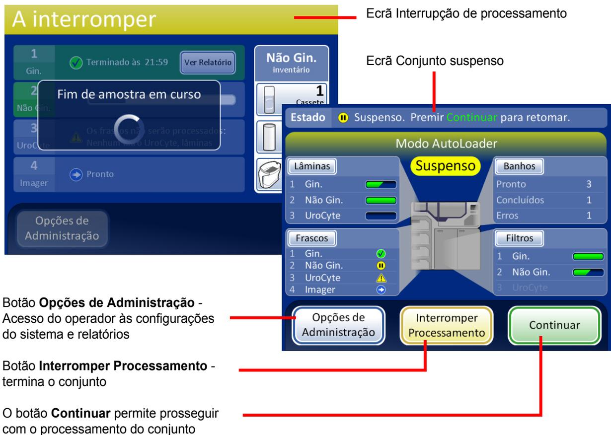
Figura 6-22 Ecrã Processamento interrompido
