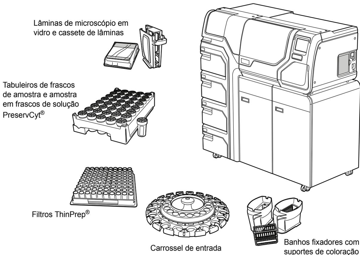
Figura 1-3 Componentes do processador ThinPrep 5000 com AutoLoader
