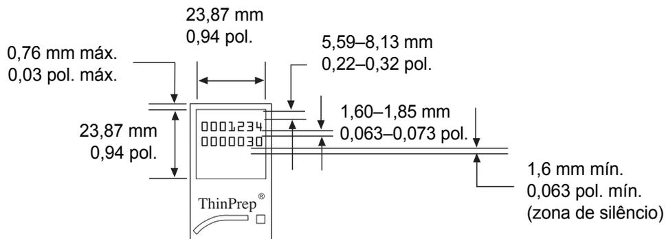
Figura 7-22 Etiquetas com formato OCR para lâminas
