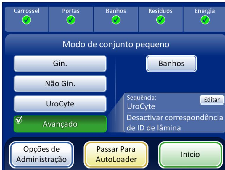
Figura 7-26 Desativar correspondência de ID de lâmina selecionada
