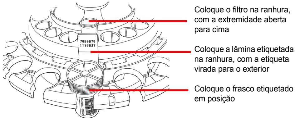
Figura 7-23 Carregar o carrissel com frascos, lâminas e filtros
