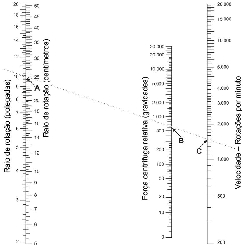
Figura 5-2 Determinação da velocidade de centrifugação correta
