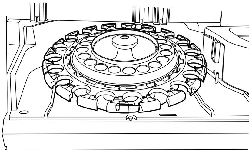
Figura 7-11 Colocar o carrossel no processador
