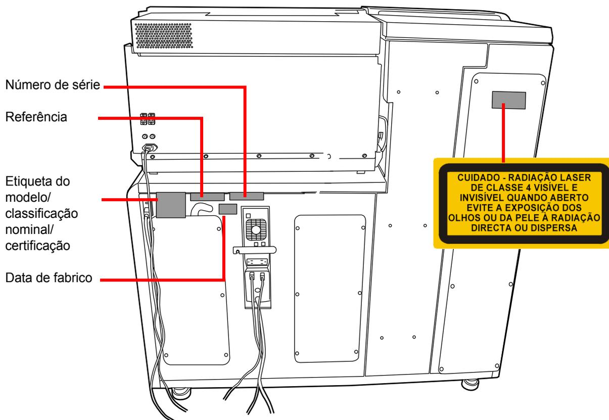
Figura 1-7 Parte de trás do Processador ThinPrep® 5000 com AutoLoader
