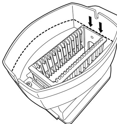
Figura 7-9 Banho fixador e suporte de coloração
