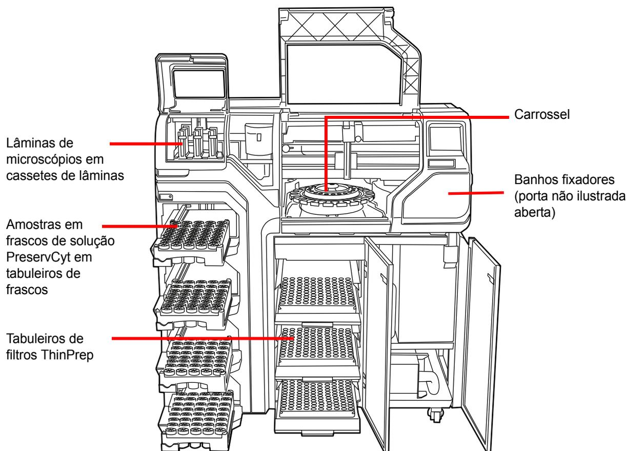
Figura 7-3 Carregamento do instrumento
