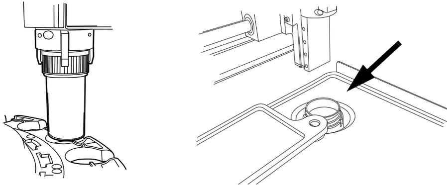
Figura 9-5 Libertar frasco, verificar poço de dispersão
