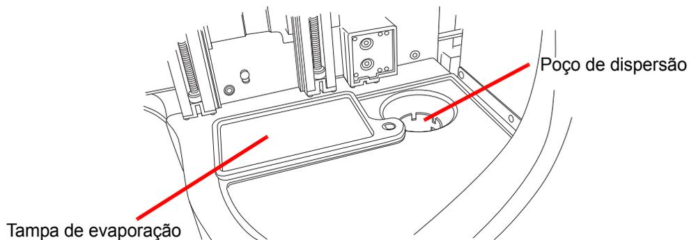
Figura 8-3 Limpeza da área do poço de dispersão
