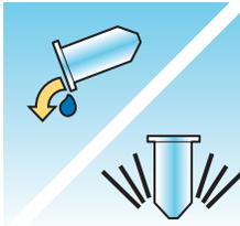
Decante o sobrenadante na sua totalidade para concentrar de forma eficaz a amostra. Para isso, inverta o tubo de centrifuga 180° num movimento suave, decante todo o sobrenadante e, depois, volte a colocar o tubo na respetiva posição original, como ilustrado na Figura 5-3.<sup>1</sup> Observe o pellet de células durante a inversão para evitar a perda acidental de material celular.
