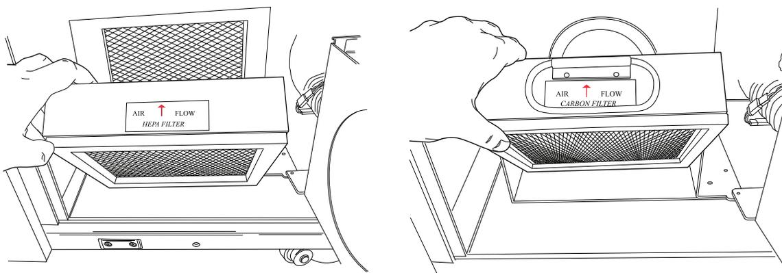
Figura 8-21 Remoção dos filtros HEPA e de carbono
