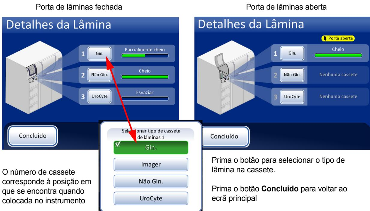
Figura 6-5 Ecrã Detalhes da lâmina
