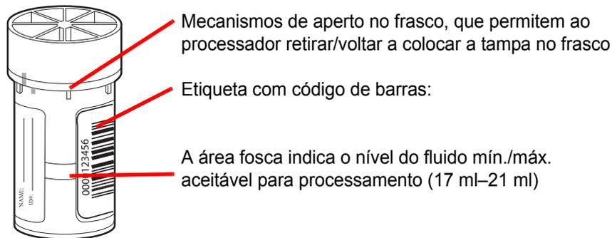
Figura 7-2 Frasco de amostra de Solução PreservCyt
