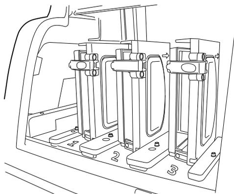
Figura 7-5 Colocar as cassetes de lâminas
