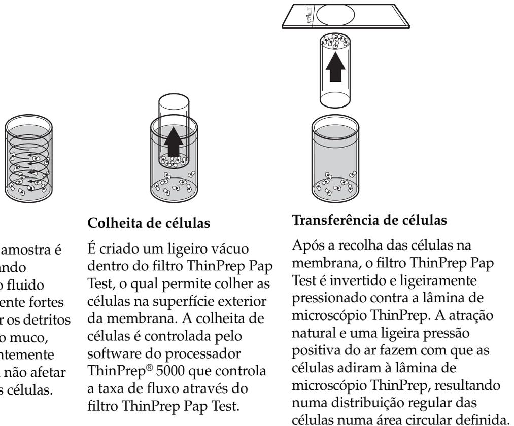
Figura 1-2 Processo de preparação de amostras ThinPrep
