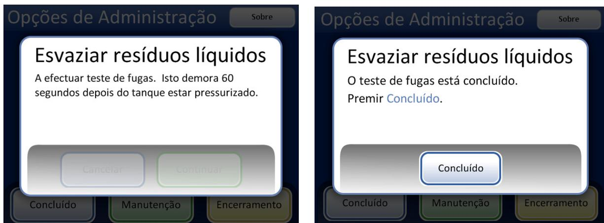
Figura 8-14 Ensaio de fugas do sistema de resíduos
