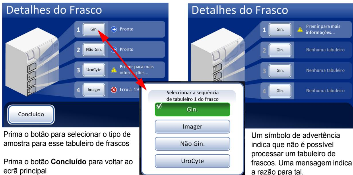
Figura 6-7 Seleção da sequência de tabuleiros de frascos (tipo de amostra)
