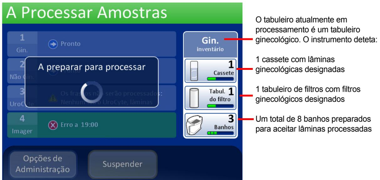
O tabuleiro atualmente em processamento é um tabuleiro ginecológico. O instrumento deteta:
