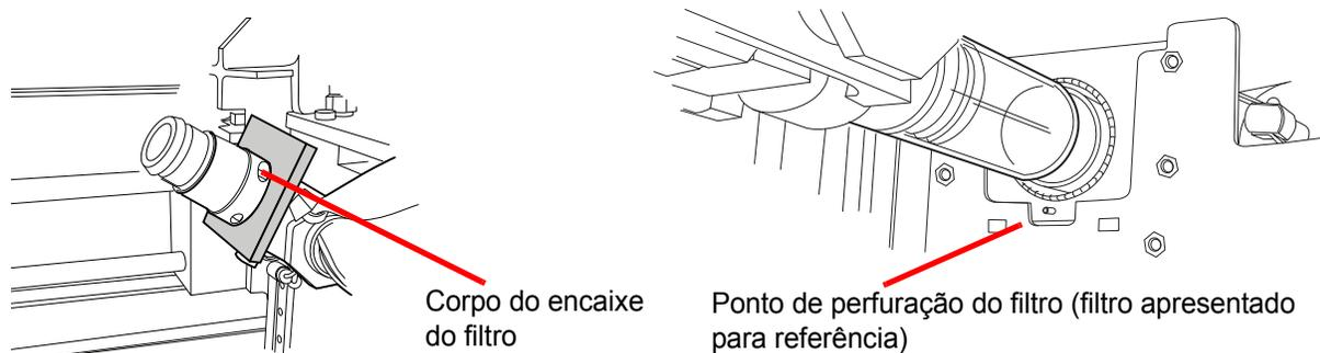
Figura 8-4 Limpeza do encaixe do filtro e da área de perfuração do filtro
