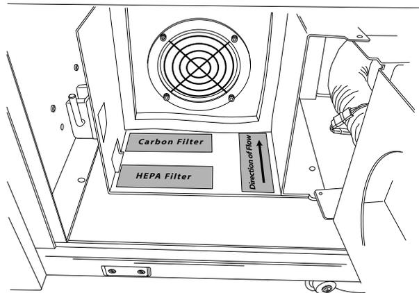
Figura 8-22 Etiquetas dos filtros do extrator de fumaça
