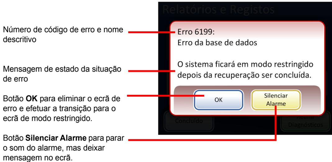
Figura 9-1 Detecção de um erro pelo sistema
