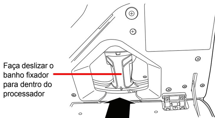
Figura 7-10 Colocar o banho fixador no processador
