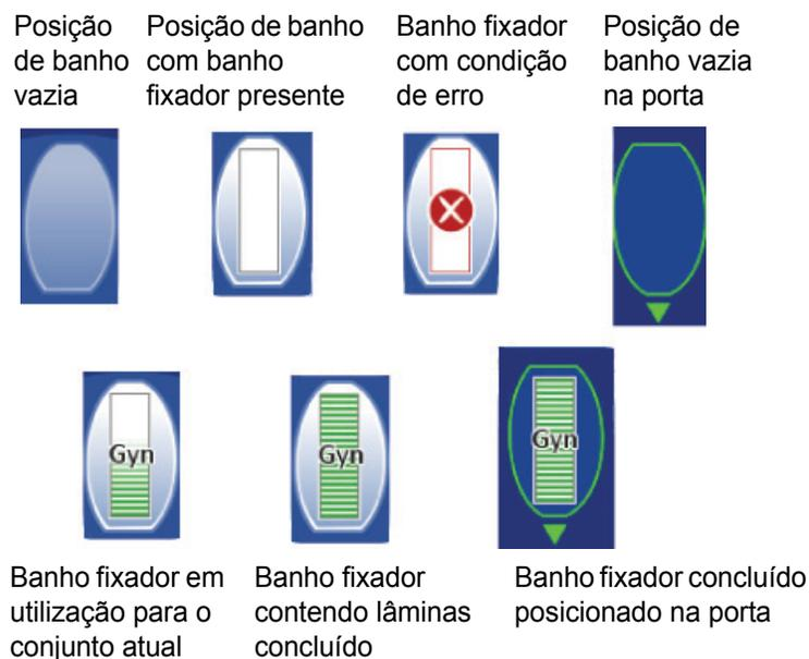
Figura 6-12 Estado do banho fixador - lâminas ginecológicas como exemplo
