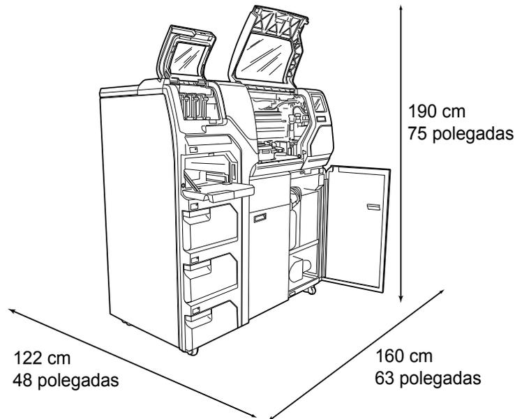
Figura 1-5 Dimensões e espaços livres do processador ThinPrep 5000 com AutoLoader
