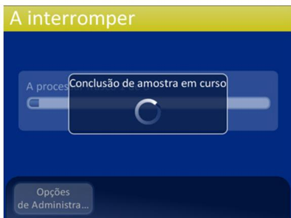
Depois de premir o botão **Suspender**, o estado muda para A interromper quando o sistema termina o frasco em curso e coloca os mecanismos em repouso
