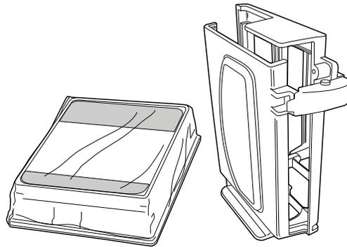
Figura 7-4 Lâminas de microscópio e cassete
