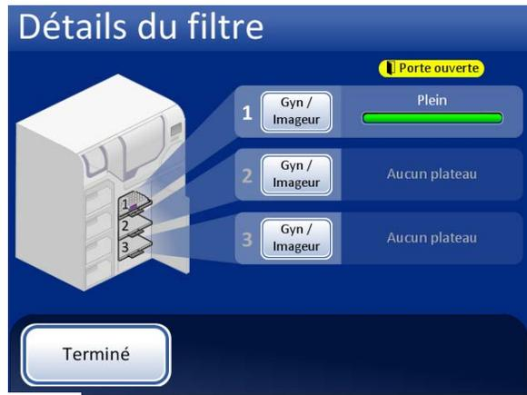
Le numéro du plateau de filtres correspond à la position à laquelle il se trouve lors de son installation dans l'appareil
