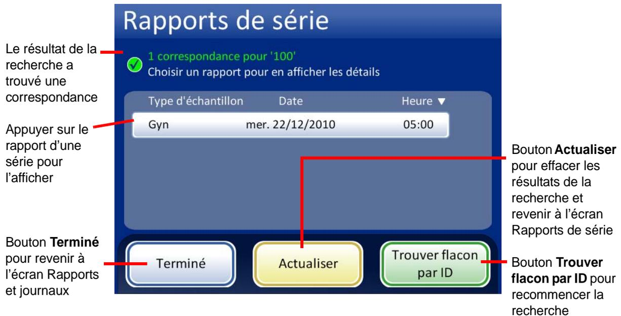
Figure 6-59 Écran des résultats de la recherche d'un flacon par son numéro d'identification
