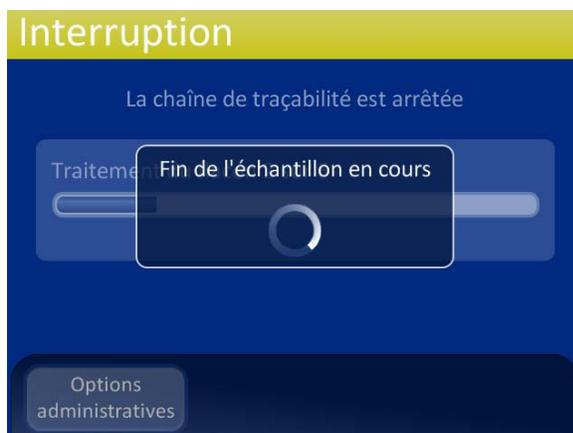
Après avoir appuyé sur le bouton **Pause**, l'état passe à Interruption car le système termine le flacon en cours et met les mécanismes en attente
