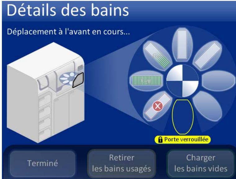
Lorsque les bains sont déplacés, la porte se verrouille pendant que le carrousel pivote.
