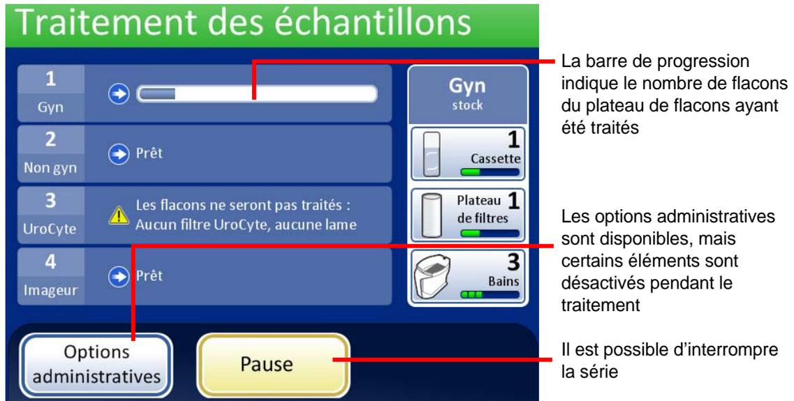
Figure 7-14 Écran Traitement des échantillons
