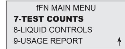
TEST COUNTS (Pruebas realizadas) se muestra en dos pantallas. Puede acceder a cada pantalla presionando las teclas ← y →.
