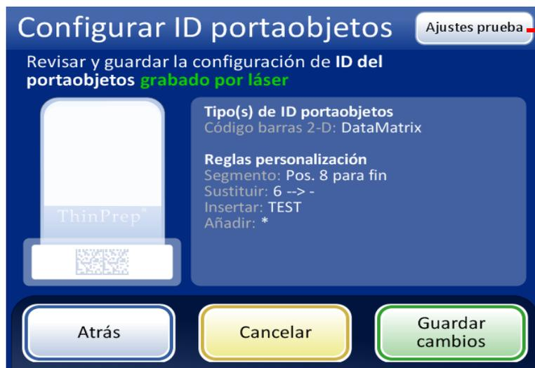
Use el botón **Ajustes prueba** para comprobar la configuración del ID del vial y del ID del portaobjetos; para ello, escanee la etiqueta del vial
