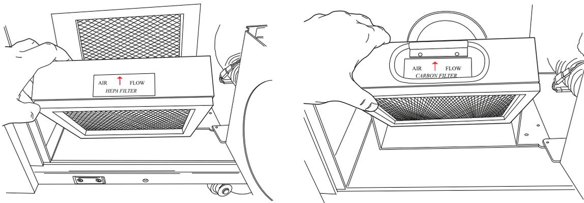
Figura 8-22 Extracción de los filtros HEPA y de carbono
