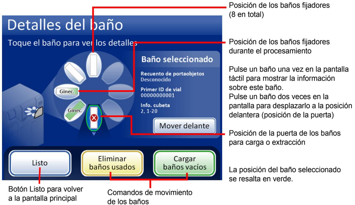
Figura 6-10 Pantalla Detalles del baño
