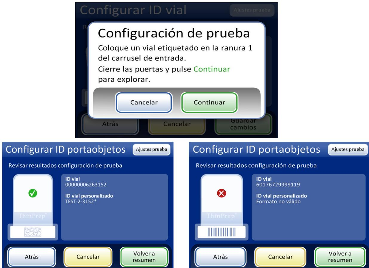
Configuración del ID del portaobjetos correcta. La información de la configuración del ID del vial coincide con la etiqueta del vial escaneada. En este ejemplo, el ID del portaobjetos para la muestra en este vial se grabaría como "TEST-2-3152\*". (Ver Figura 6-69.)
