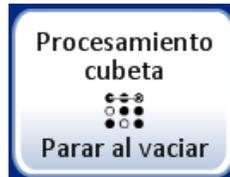
Durante el procesamiento, el procesador ThinPrep 5000 con autocargador mueve viales de la cubeta para viales al carrusel. El instrumento se puede configurar para que detenga la carga de viales en una ranura vacía en la cubeta para viales, o para continuar por delante de ranuras vacías en la cubeta para viales.
