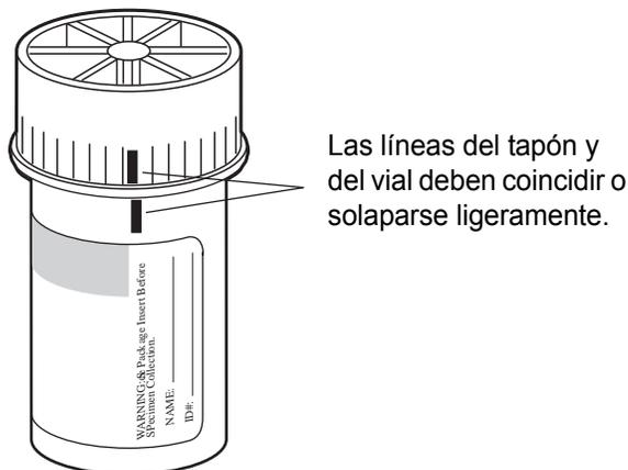
Figura 3-1 Alineación del tapón del vial
