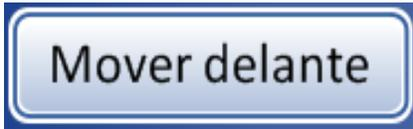
**Mover delante:** para mover un baño fijador hacia la puerta, pulse el botón “Mover delante” con el baño seleccionado, o bien pulse dos veces la posición que ocupa en la pantalla. El sistema bloquea la puerta y se mueve hasta la posición que queda delante de la puerta. Cuando la puerta se desbloquea, se puede abrir y extraer el baño fijador.
