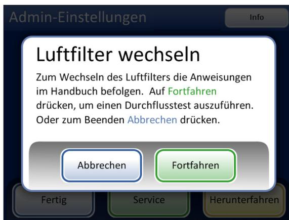
Meldung zum Wechseln des HEPA-Filters. Diese Meldung wird bei Aufforderung des Geräts oder beim Drücken der Schaltfläche **Luftfilter wechseln** im Bildschirm „Admin-Einstellungen“ angezeigt.
