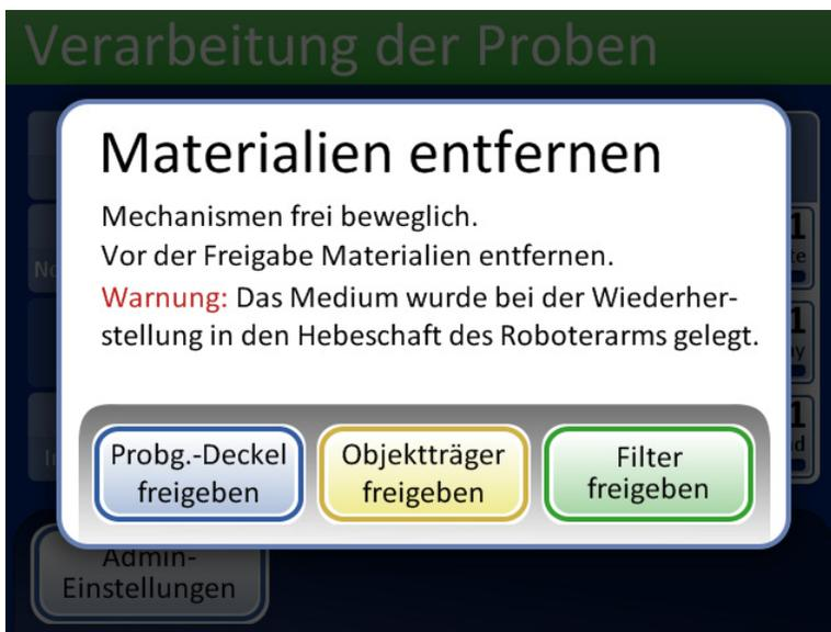
**Probg.-Deckel freigegeben** öffnet die Finger des Fläschchengreifers, um den Probengefäßdeckel fallen zu lassen.
