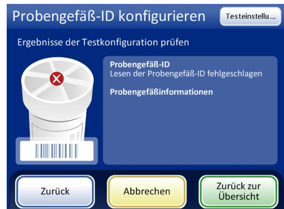
Wenn die Probengefäß-ID auf dem Probengefäß nicht den für die Probengefäß-ID konfigurierten Kriterien entspricht, meldet die Bildschirmanzeige, dass das Gerät die Probengefäß-ID nicht lesen konnte. Korrigieren Sie die Probengefäß-ID auf dem Etikett oder korrigieren Sie die Konfiguration der Probengefäß-ID vor der Probenverarbeitung.
