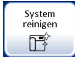
Verwenden Sie die Schaltfläche **System reinigen** in mehreren wöchentlichen Reinigungsaktivitäten. Die Schaltfläche „System reinigen“ bewegt die mechanischen Arme in Bereiche im Verarbeitungsbereich, um die Bereiche für die routinemäßige Instandhaltung leichter erreichbar zu machen.
