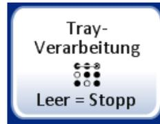
Während der Verarbeitung bewegt der ThinPrep 5000 Prozessor mit AutoLoader die Probengefäße vom Probengefäß-Tray zum Karussell. Das Gerät kann so konfiguriert werden, dass das Laden von Probengefäßen bei einer leeren Position im Probengefäß-Tray gestoppt oder nach leeren Positionen im Probengefäß-Tray fortgesetzt wird.
