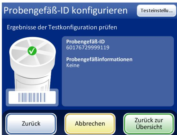
Erfolgreiche Konfiguration der Probengefäß-ID. Die Informationen zur Probengefäß-ID-Konfiguration stimmen mit dem gescannten Probengefäß-Etikett überein. In diesem Beispiel hat die Probengefäß-ID eine Zugangs-ID von „60“ und es gibt neben der Zugangs-ID zwei zusätzliche Felder in der Probengefäß-ID. Diese Konfiguration entspricht einem Probengefäß, das mit „60|7672999|9“ auf dem Probengefäß-Etikett bedruckt ist.
