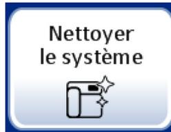
Utiliser le bouton **Nettoyer le système** au cours de plusieurs activités de maintenance hebdomadaire. Le bouton Nettoyer le système déplace les bras mécaniques dans la zone de traitement jusqu'aux positions qui facilitent leur accès pour la maintenance de routine.
