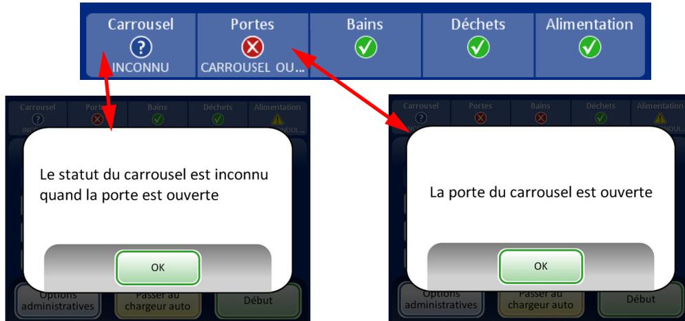
Figure 7-19 Exemples de messages des indicateurs d'état
