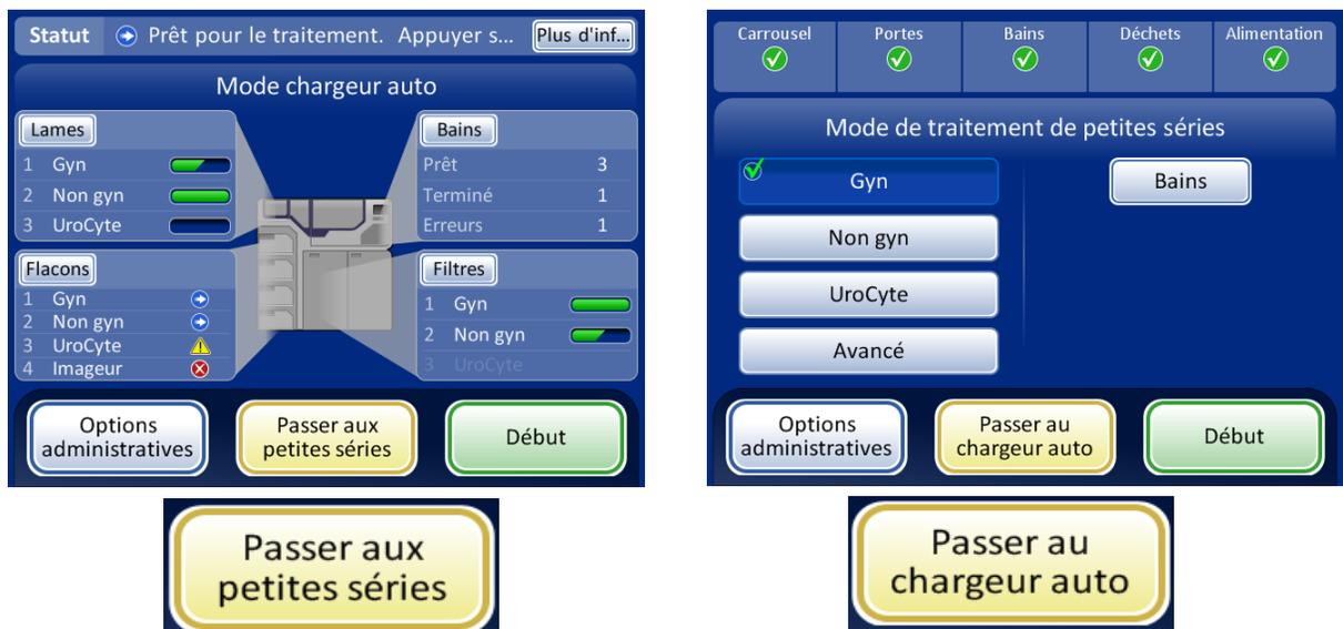
Figure 6-24 Boutons de basculement du mode
