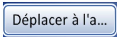
**Déplacer à l'a...** - Pour déplacer un bain fixateur vers la porte, toucher le bouton Déplacer à l'a... pour le bain sélectionné ou appuyer deux fois sur l'emplacement qu'il occupe à l'écran. Le système verrouille la porte et déplace l'emplacement devant la porte. Lorsque la porte se déverrouille, il est possible de l'ouvrir et de retirer le bain fixateur.
