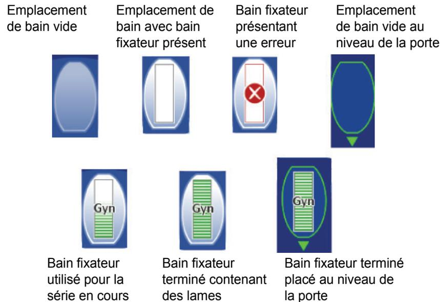
Figure 6-12 Statut des bains fixateurs - Exemple avec des lames gynécologiques (Gyn)
