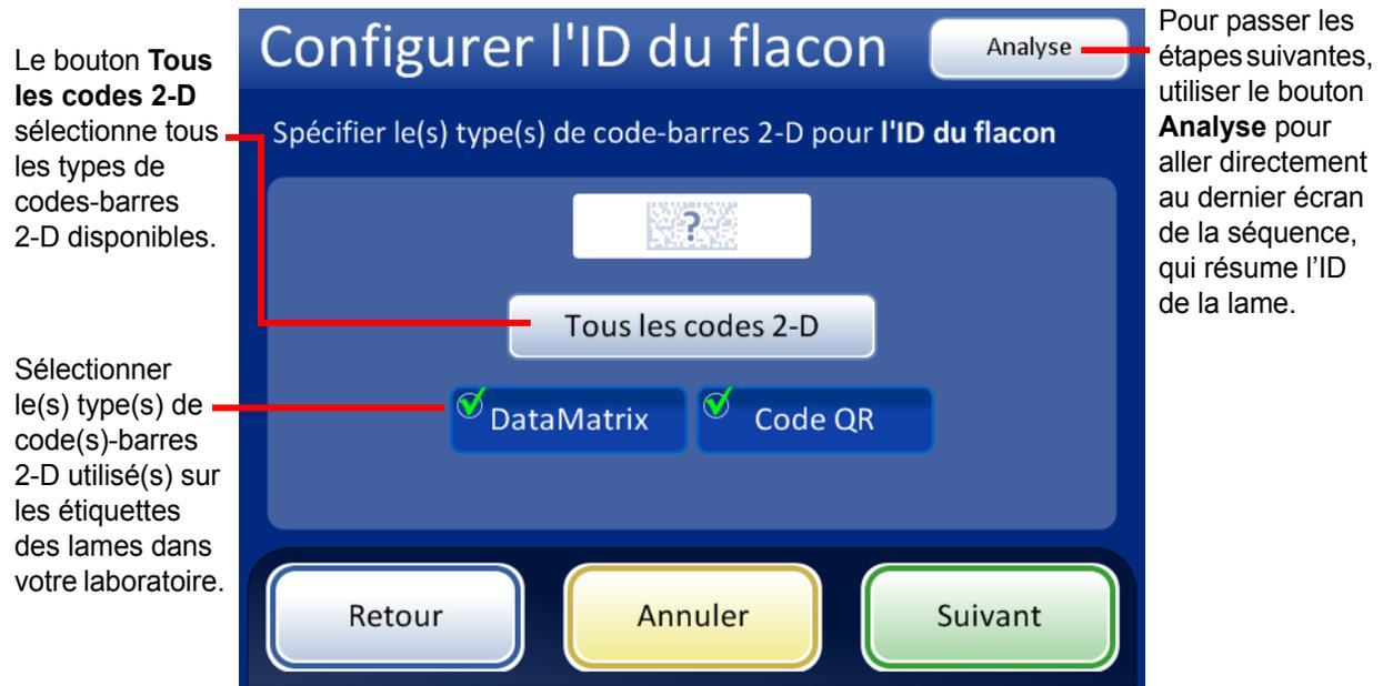
Figure 6-74 Spécifier le(s) type(s) de code(s)-barres 2-D pour les ID de lame pré-étiquetée
