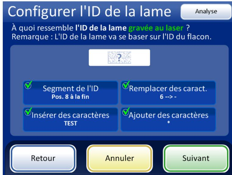
Figure 6-69 Écran de résumé de la configuration de l'ID pour les lames gravées au laser
