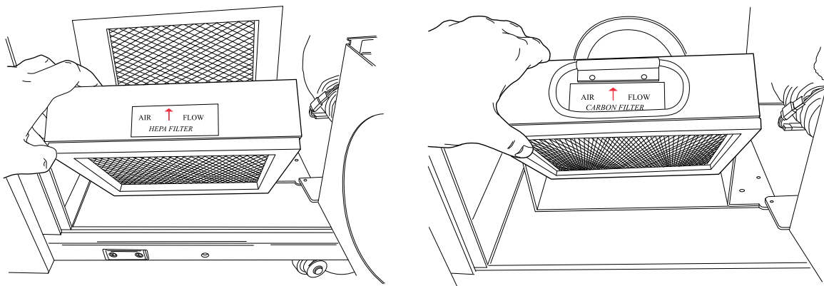
Abb. 8-21 Den HEPA- und Kohlefilter herausnehmen
