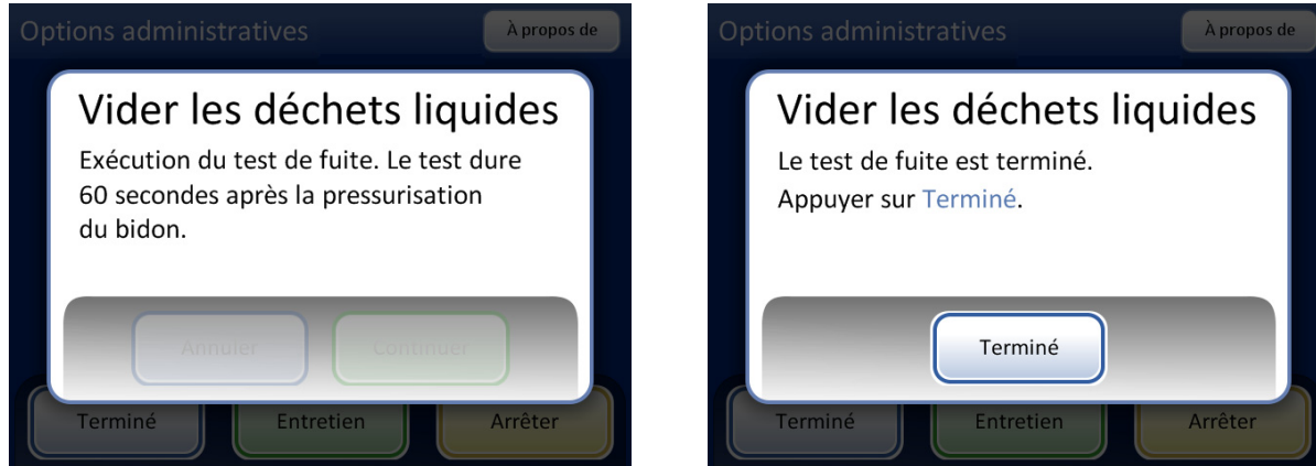
Figure 8-15 Test de fuite du système d'évacuation des déchets
