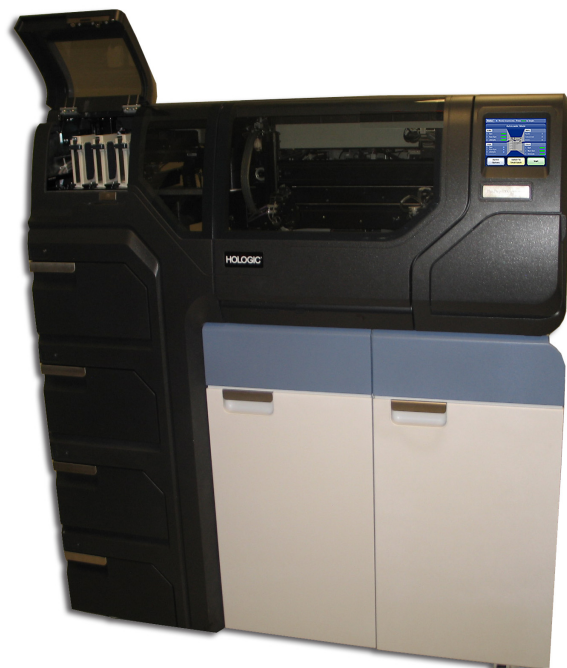
Figure 2-1 Un processeur ThinPrep 5000 avec AutoLoader type
