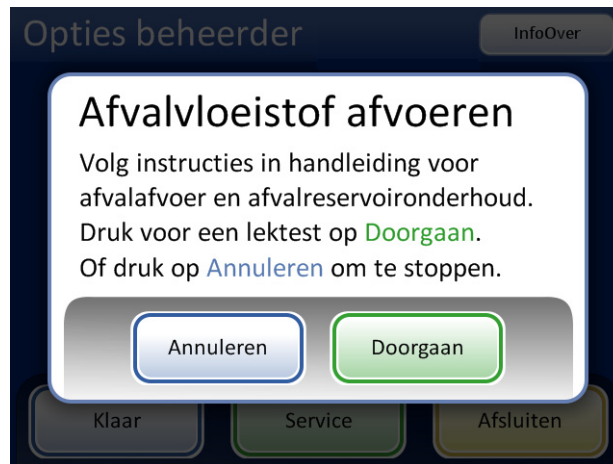
Afbeelding 8-12 De afvalfles legen en onderhoud plegen
