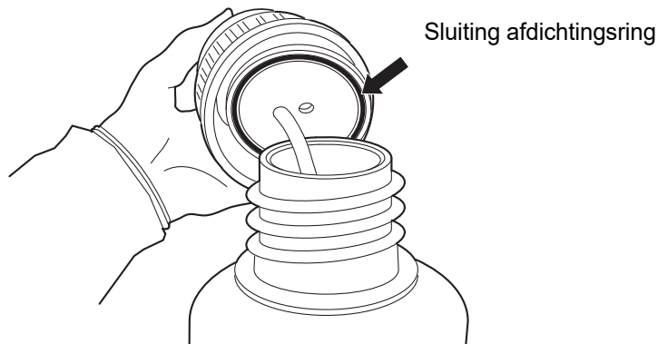
Afbeelding 8-14 Inspecteer de afdichtingsring van de afvalfles
