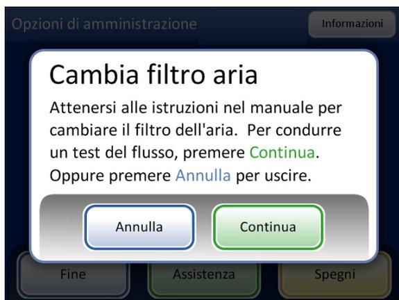
Messaggio che segnala all'utente di sostituire il filtro HEPA. Questo messaggio viene visualizzato quando il sistema rileva che il filtro deve essere sostituito oppure se si preme il pulsante **Cambia filtro aria** nella schermata Opzioni di amministrazione.
