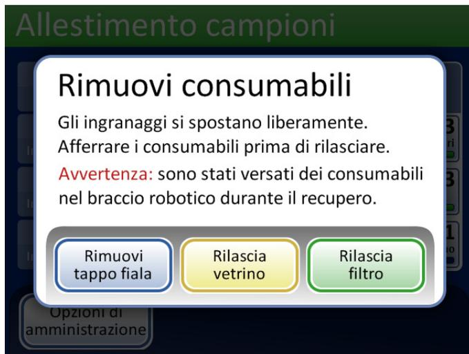
L’opzione **Rimuovi tappo fiala** consente di aprire le dita del dispositivo di presa per fiale in modo da consentire il rilascio del tappo della fiala.
