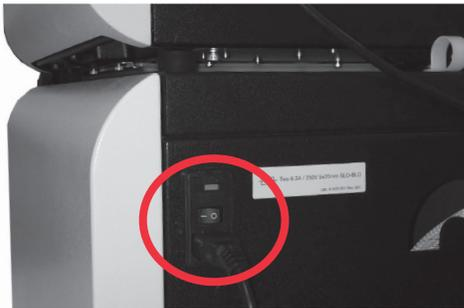
Verificare che l'interruttore di alimentazione sul lato posteriore destro dell'AutoLoader, sopra il cavo di alimentazione, sia acceso. Lasciarlo acceso. Chiudere tutti gli sportelli.
