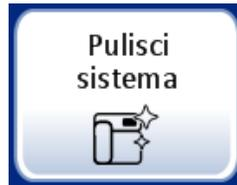
Utilizzare il pulsante **Pulisci sistema** in diverse attività di manutenzione settimanali. Il pulsante Pulisci sistema sposta i bracci meccanici nell'area di allestimento in posizioni che li rendono più facilmente raggiungibili per la manutenzione ordinaria.
