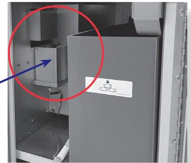
**Consiglio:** svuotare il contenitore di smaltimento dei filtri con una frequenza basata sul volume di campioni trattati del laboratorio. Considerare lo svuotamento del contenitore di smaltimento dei filtri ad ogni svuotamento della tanica di scarico dei liquidi.
