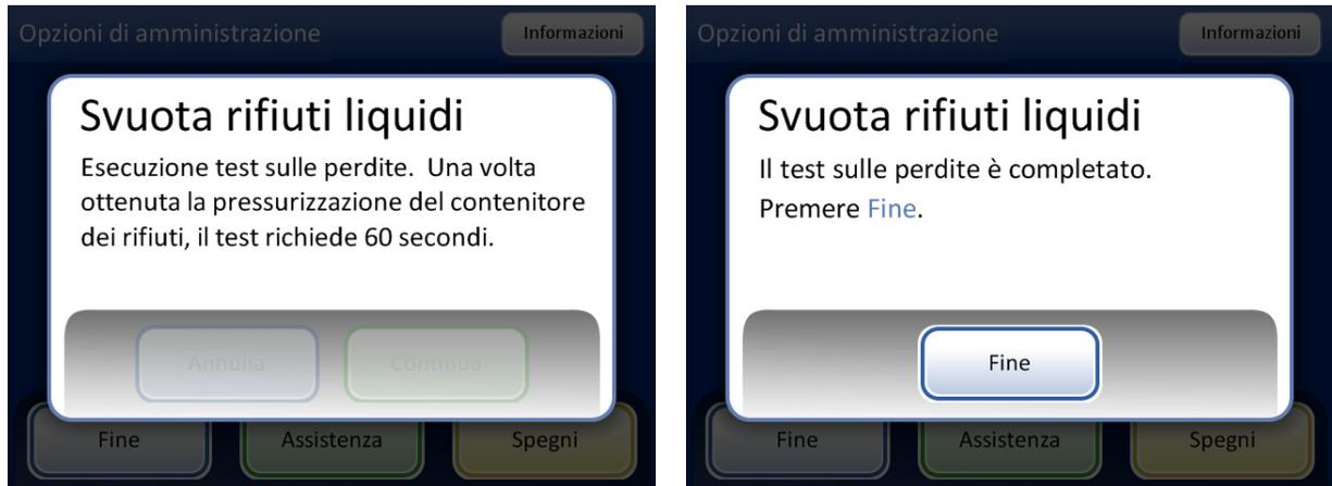
**Figura 8-15 Test sulle perdite del sistema di scarico**
