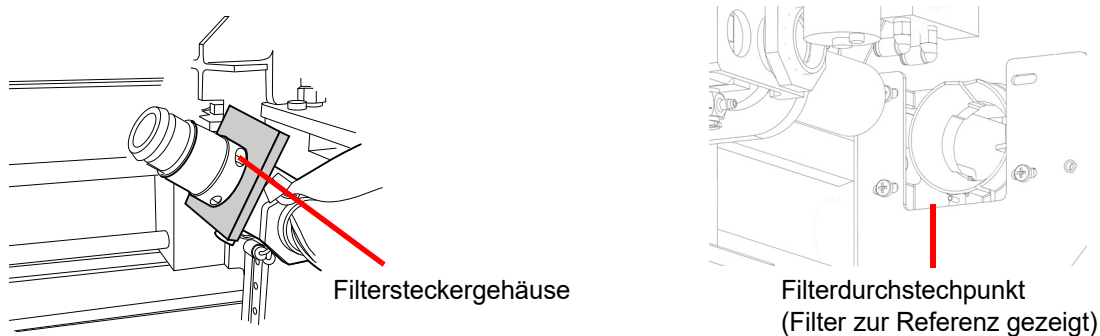
Abb. 8-4 Filterstecker und Filterdurchstechbereich reinigen
