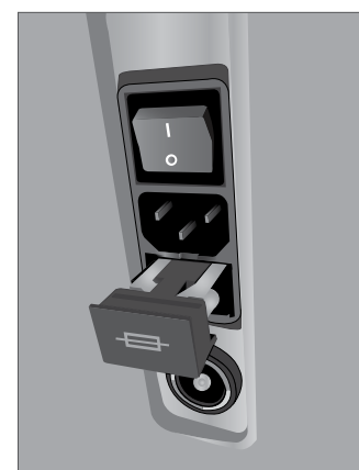
Ubicación del fusible
