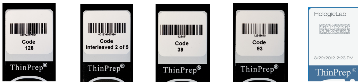
Фигура 7-3 Примери за начина на пасване на барковете върху предметно стъкло ThinPrep
