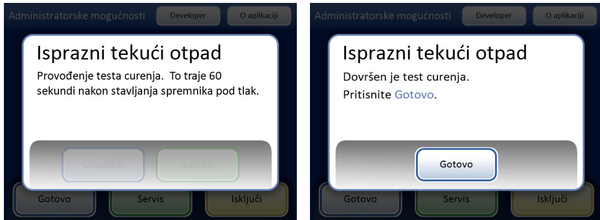
Slika 8-15 Test curenja sustava otpada
