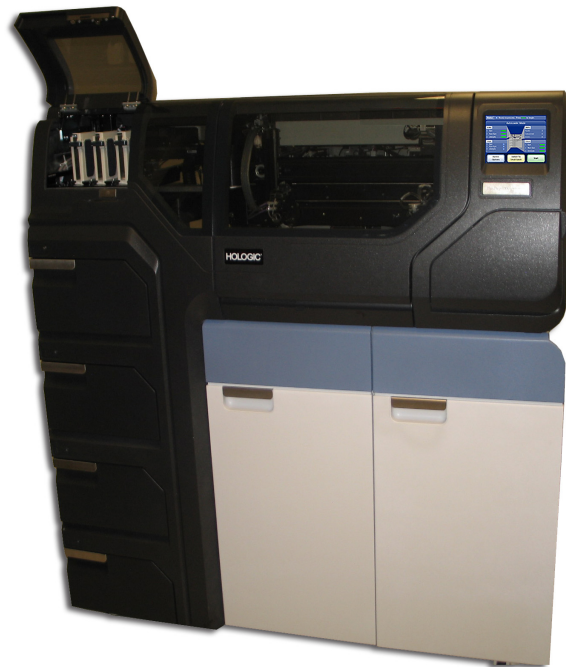
Joonis 2-1 Tavapärane automaatlaadijaga tötlusseade ThinPrep 5000
