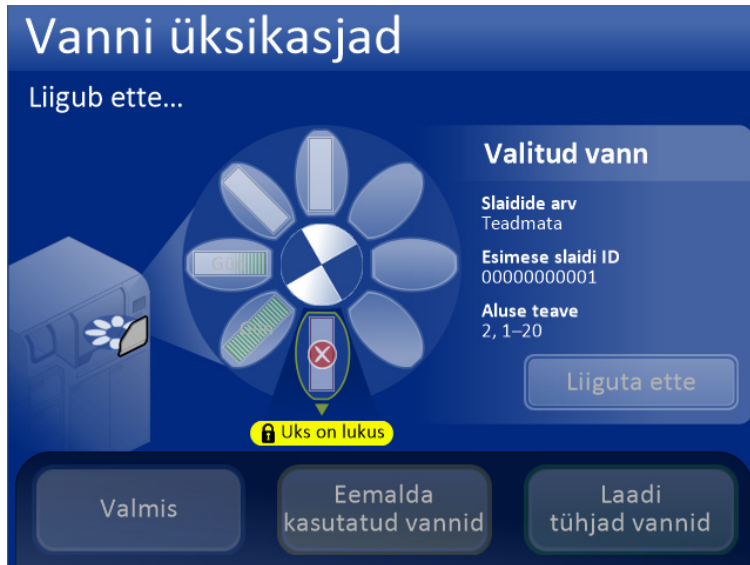
Joonis 6-11 Vann liigub ukse juurde
