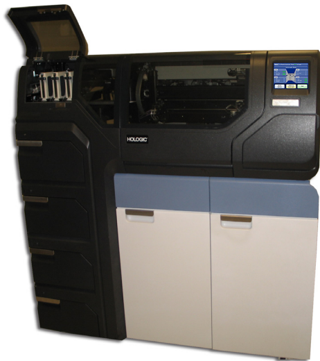
Kuva 1-1 ThinPrep 5000 -prosessointilaitte ja automaattilatain
