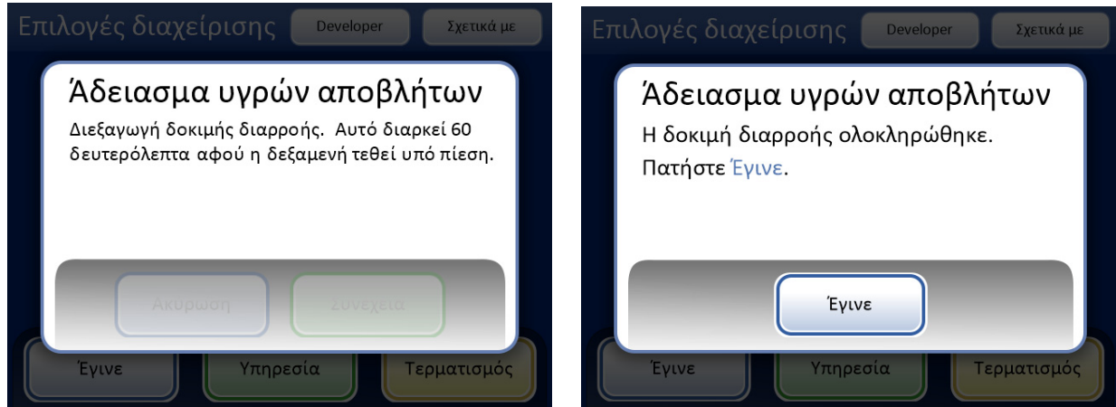
Εικόνα 8-15 Δοκιμή διαρροής συστήματος αποβλήτων
