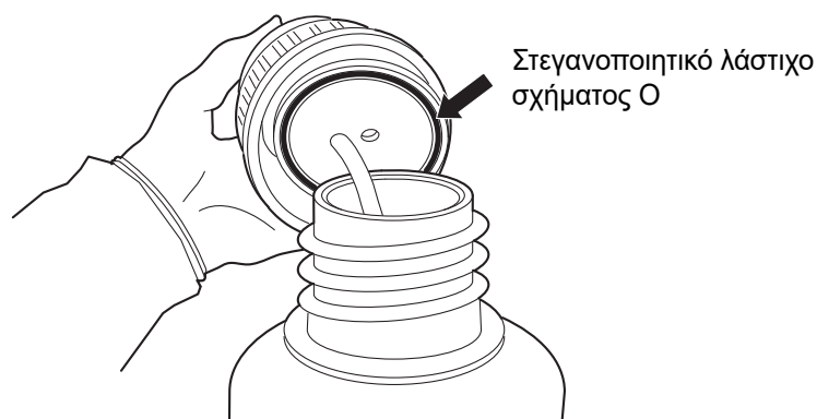
Εικόνα 8-14 Επιθεώρηση της στεγανότητας του λάστιχου σχήματος O της φιάλης αποβλήτων
