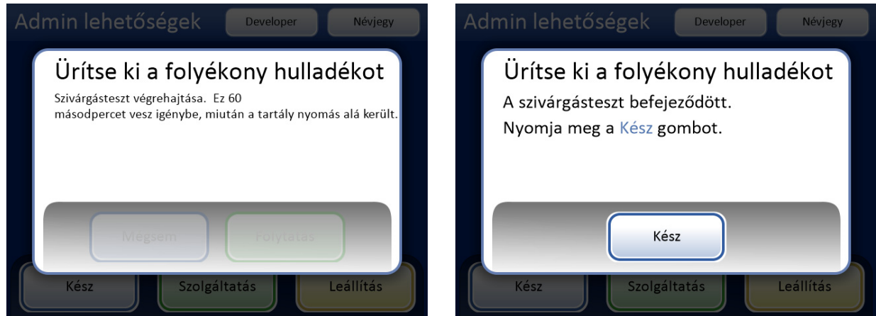
8–15. ábra A hulladékrendszer szivárgástesztje
