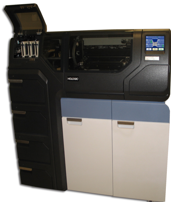
2-1 pav. Tipinis „ThinPrep 5000“ procesorius su „AutoLoader“
