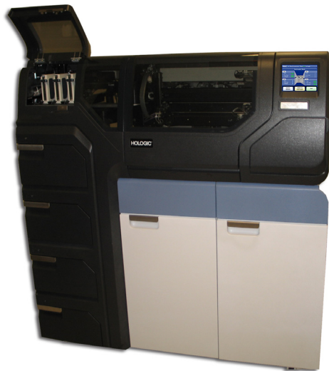
1-1 pav. „ThinPrep 5000“ procesorius su „AutoLoader“
