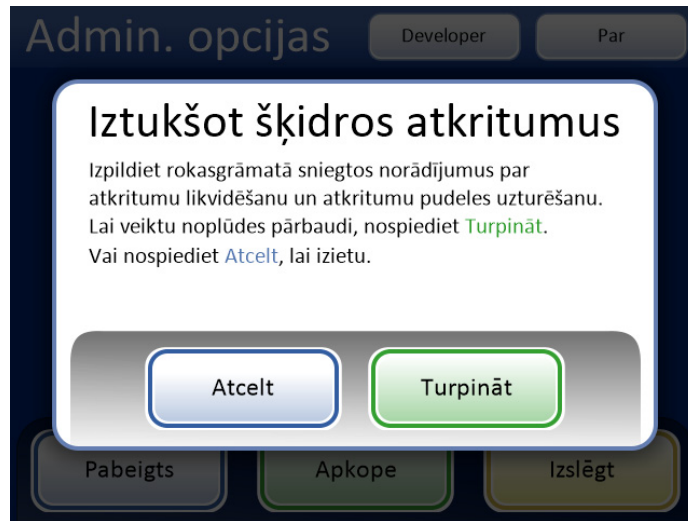
8-12 attēls. Atkritumu pudeles iztukšošana un uzturēšana
