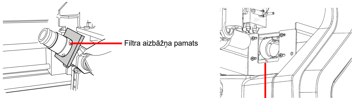
Filtra caurduršanas punkts (filtrs parādīts šeit atsaucei)
