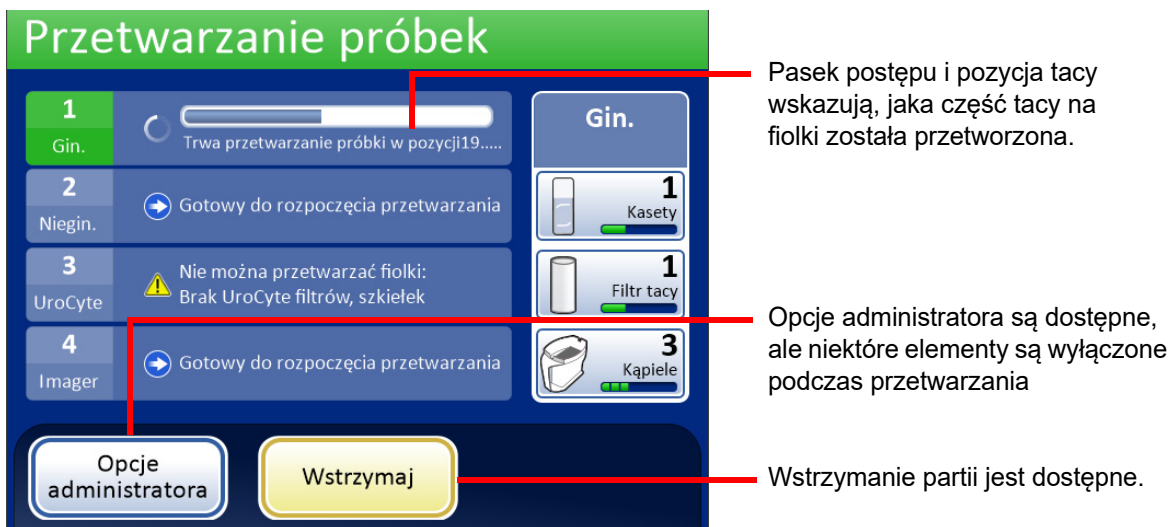
Rycina 7-14 Ekran przetwarzania próbek
