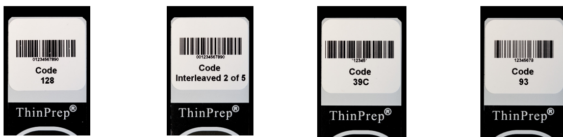
Rycina 7-20 Przykłady dopasowania kodów kreskowych do szkiełka ThinPrep
