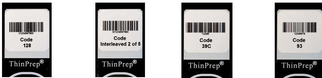
Slika 7-20 Primeri prileganja črtnih kod preparatom ThinPrep
