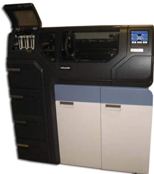
Figura 2-1 Un tipico processore ThinPrep 5000 con AutoLoader
