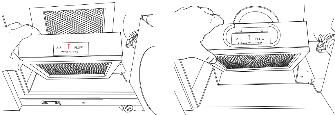
Figura 8-21 Rimozione dei filtri HEPA e in carbonio
