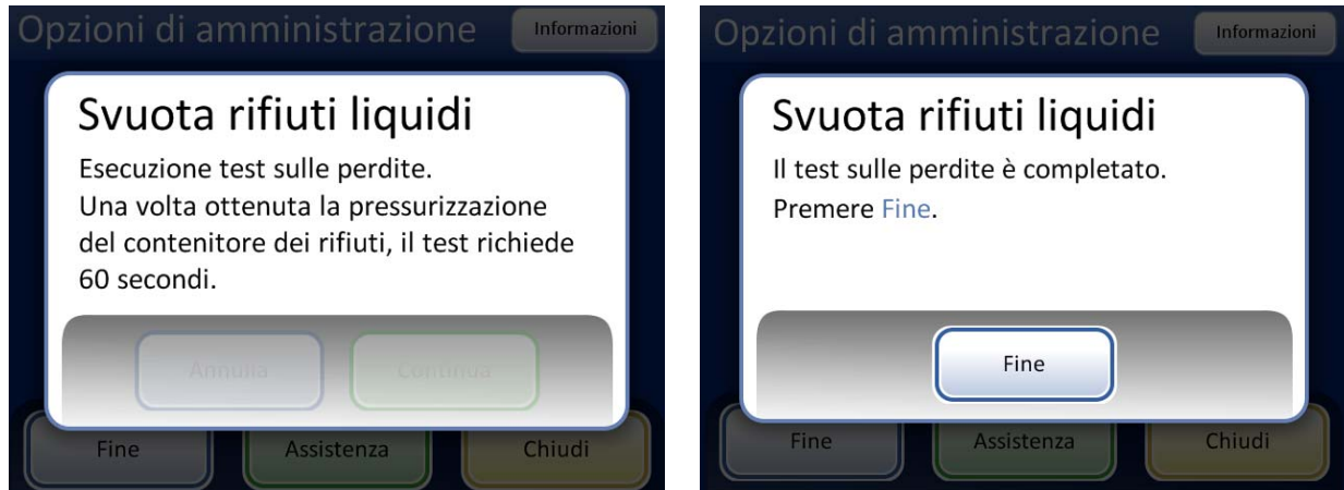
Figura 8-14 Test sulle perdite del sistema di scarico
