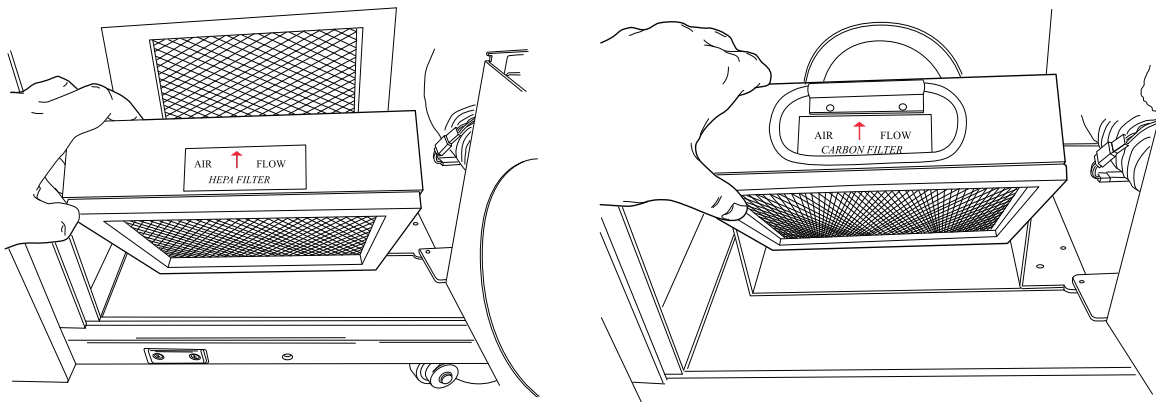
Afbeelding 8-21 Het HEPA-filter en het koolstoffilter verwijderen
