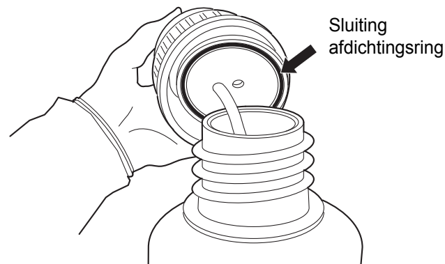
Afbeelding 8-13 De afdichtingsring van de afvalfles inspecteren
