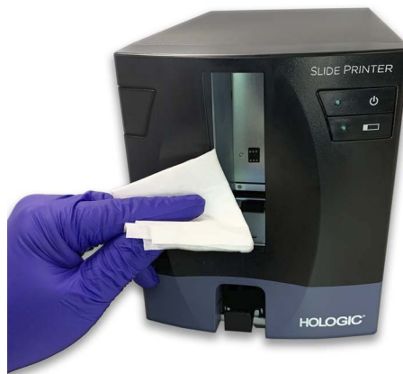
Obrázek 8-11 Čištění vstupního válečku na tiskárně štítků na sklíčka
