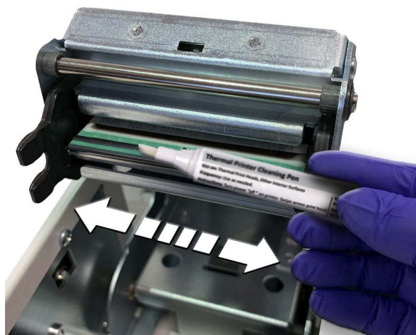
Obrázek 8-7 Otřete čistící pero o tiskovou hlavu tiskárny
