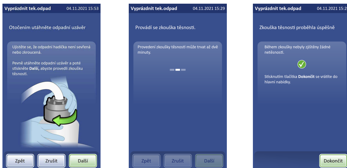
Obrázek 8-17 Utažení uzávěru a provedení zkoušky těsnosti odpadního systému
