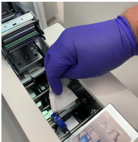
Obrázek 8-10 Otírání přepravních válečků tiskárny štítků na sklíčka
