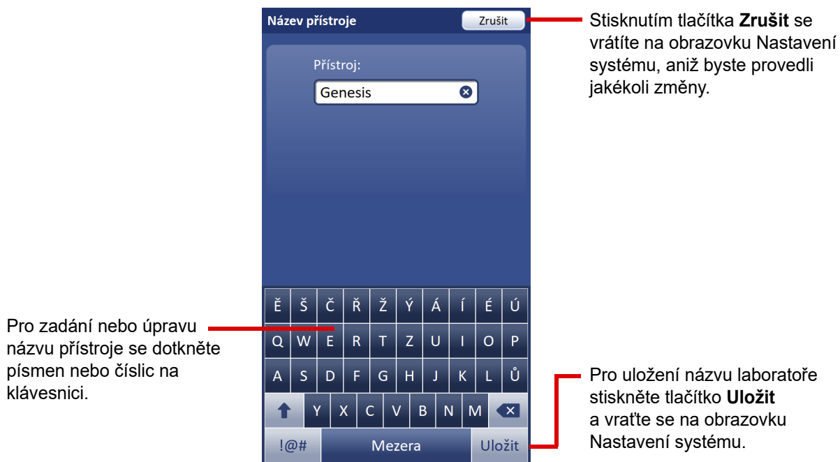
Obrázek 6-20 Zadání nebo úprava názvu přístroje pomocí klávesnice
