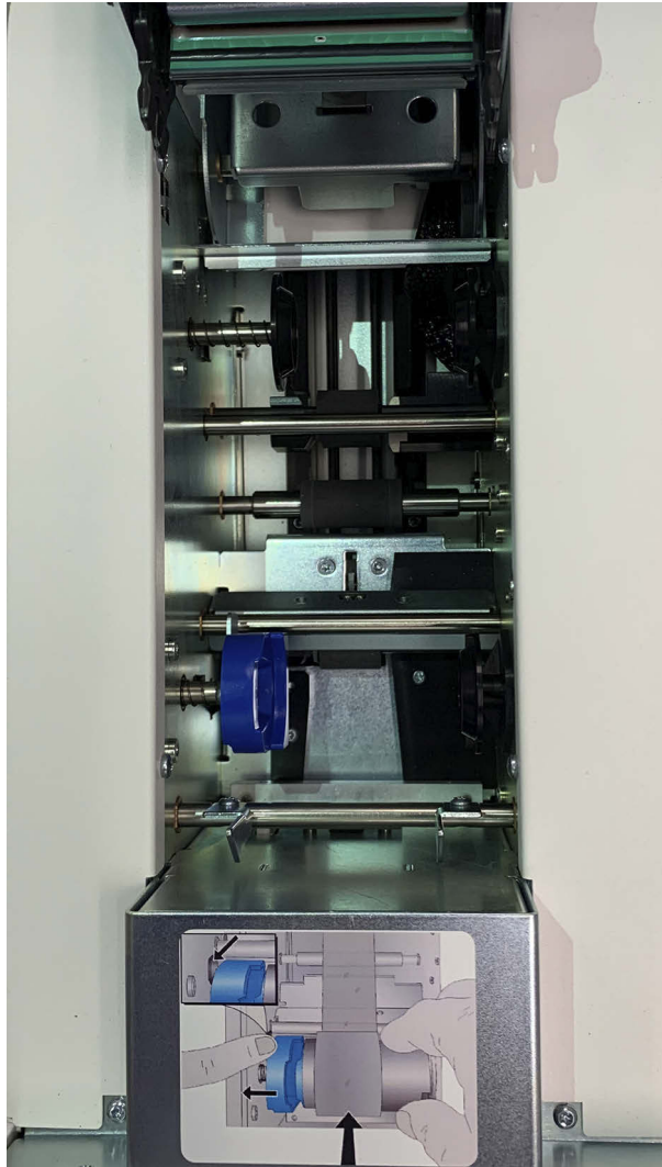
Obrázek 8-9 Převodní válce tiskárny štítků na sklíčka
