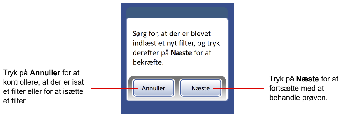
Figur 9-1 Bekræft at der er sat et filter i processoren
