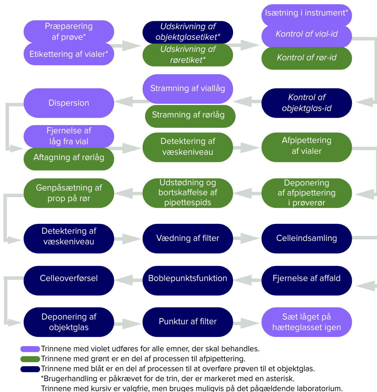
Figur 1-3 Behandling af objektglasset og afpipettering på ThinPrep™ Genesis™ processoren
