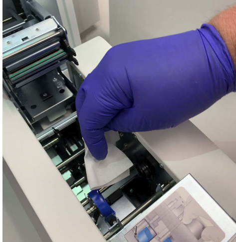
Figur 8-10 Tør objektglasprinterens transportruller af
