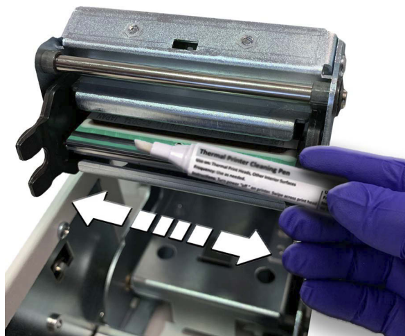
Figur 8-7 Stryg rengøringspennen hen over objektglasprinterens skrivehoved
