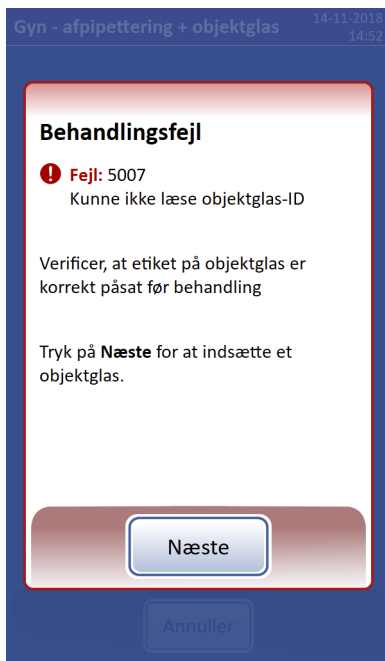
Figur 6-33 Sporbarhed slået til - processoren scanner og sammenligner objektglas-ID
