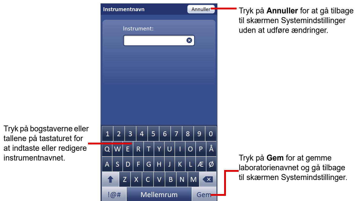
Figur 6-20 Indtaste eller redigere instrumentnavnet vha. tastaturet
