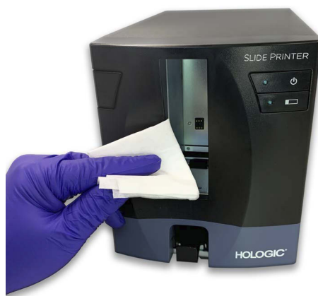
Figur 8-11 Rengør inputrullen på objektglasprinter
