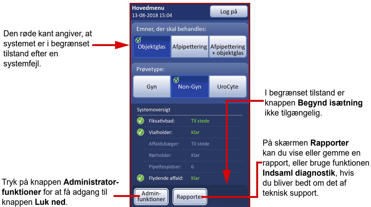
Figur 9-13 Begrænset tilstand, skærmen Hovedmenu
