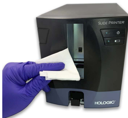
Joonis 8-11 Puhastage alusklaasi printeri sisendirullikuid
