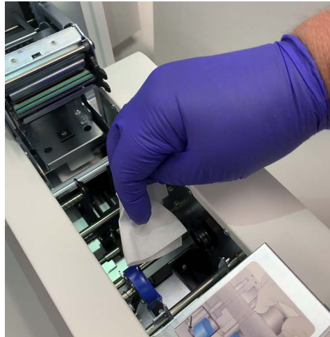
Joonis 8-10 Puhastage alusklaasi printeri transpordirullikuid
