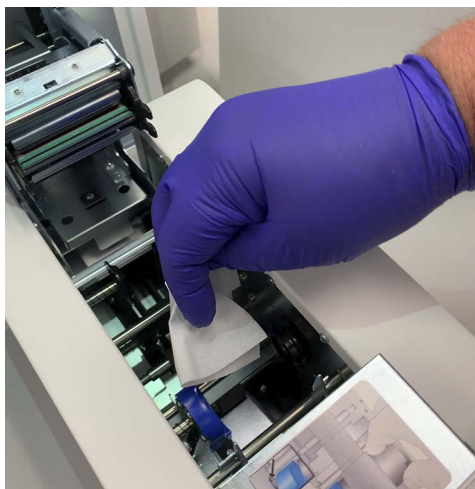
Εικόνα 8-10 Σκουπίστε τους κυλίνδρους μεταφοράς εκτυπωτή αντικειμενοφόρων
