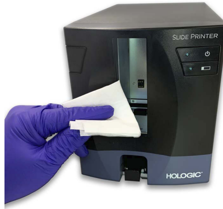
Εικόνα 8-11 Καθαρισμός κυλίνδρου εισόδου στον εκτυπωτή αντικειμενοφόρων
