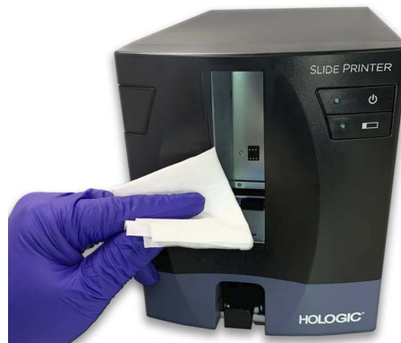
8–11 pav. Išvalykite objektnių stiklelių spausdintuvo įvesties ritinėlių.
