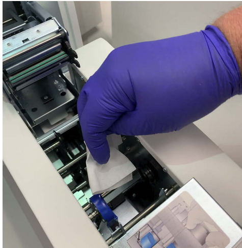
8–10 pav. Nuvalykite objektinių stiklelių spausdintuvo transportavimo ritinėlius
