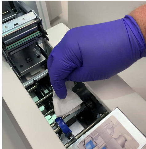
Slika 8-10 Obrišite transportne valjčke tiskalnika za preparate
