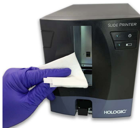
Slika 8-11 Očistite uvajalni valjček na tiskalniku za preparate
