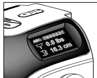
Obrázek 8: Displej kompresního zařízení
