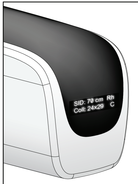
Obrázok 6: Displej na hlavici trubice
