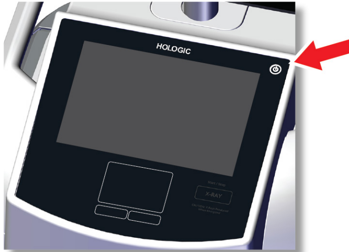
Figura 8: Interruptor de alimentación del equipo
