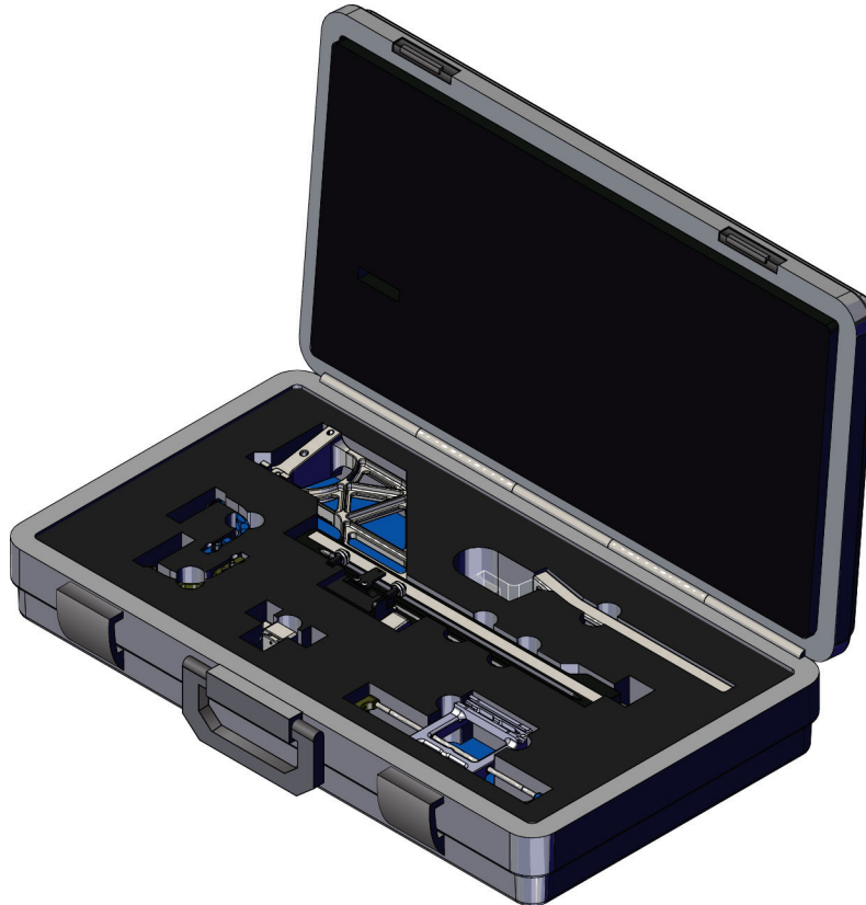
Abbildung 32: Seitenarm und Aufbewahrungskasten
