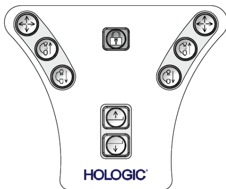
図8: コントロールハンドル -- 詳細図
