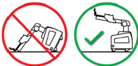
图3：如何存储活检引导模块
