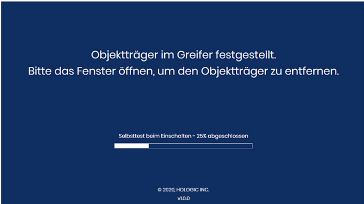
Abb. 6-6 Benutzergestützte Fehlerbehebung: Fenster öffnen, um Objektträger zu entfernen
