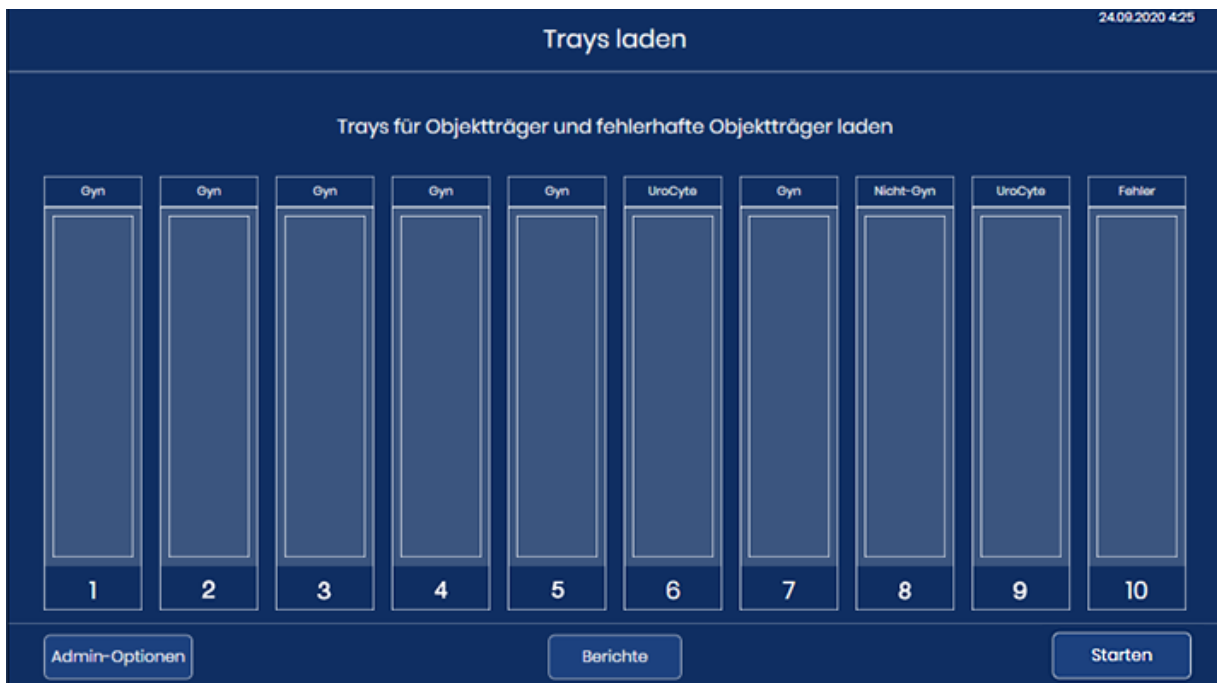
Abb. 4-11 Bildverarbeitung von Objektträgern beginnen: Objektträger-Trays laden oder Starten drücken
