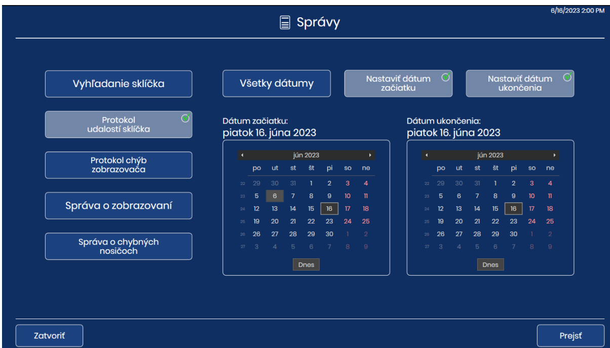
Obrázok 3-42 Protokol udalostí sklíčka: Nastavte rozsah dátumov, ťuknite na tlačidlo Prejsť
