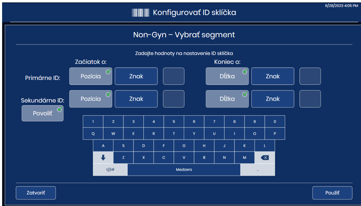
Obrázok 3-33 Nakonfigurujte ID sklíčka Non-Gyn s primárnym ID a sekundárnym ID
