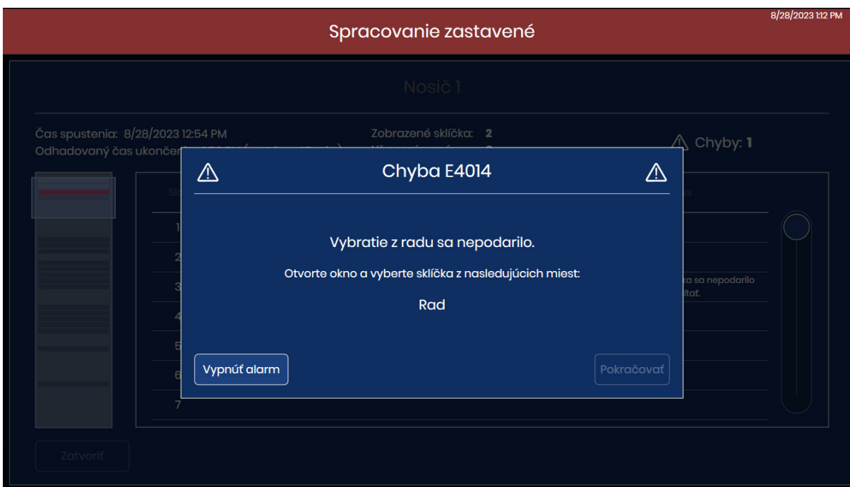
Obrázok 6-2 Oznámenie používateľovi: Odstrániteľná chyba
