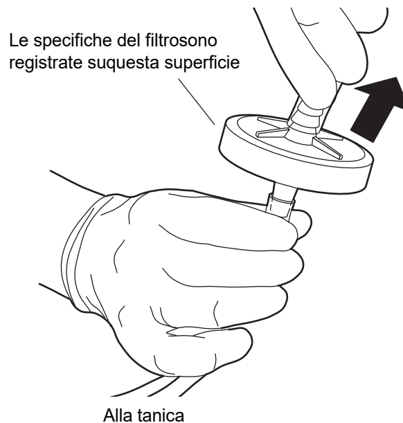
Figura 7-12 Sostituzione del filtro
