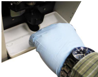
Afbeelding 7-13 Plaatsen van het opvangbakje in de behuizing. Zorg ervoor dat de schroefkoppen de uitsparingen van het opvangbakje pakken.
