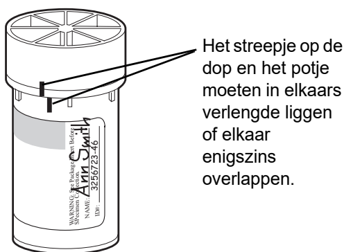
Afbeelding 3-1 Op één lijn brengen van de markering op de dop en het potje
