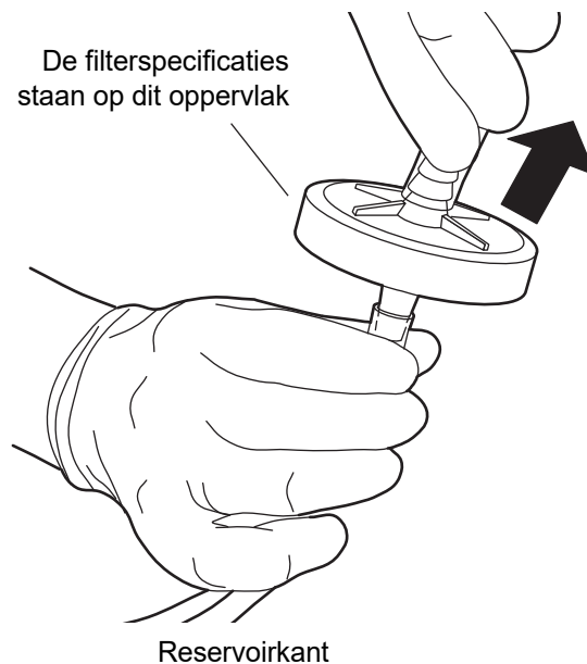
Afbeelding 7-12 Vervanging van het filter van het afvalstelsel
