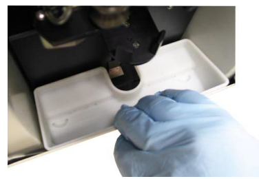
Afbeelding 7-13 Plaatsen van het opvangbakje in de behuizing. Zorg ervoor dat de schroefkoppen de uitsparingen van het opvangbakje pakken.
