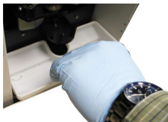
Figura 7-13 Coloque o tabuleiro de recolha no compartimento. Encaixe os parafusos nas reentrâncias do tabuleiro.
