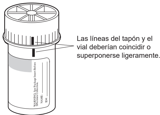
Figura 3-1 Alineación del tapón del vial
