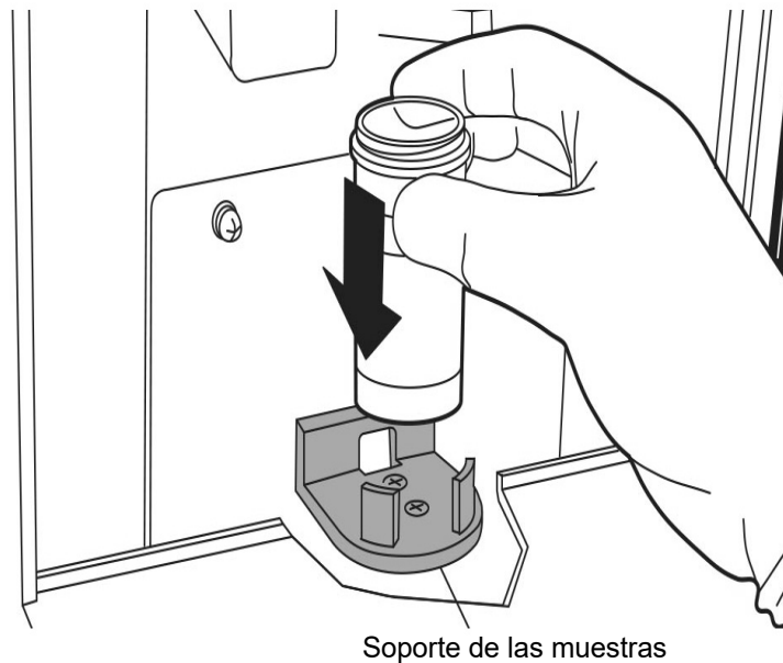
Figura 5B-8 Carga del vial de muestras PreservCyt
