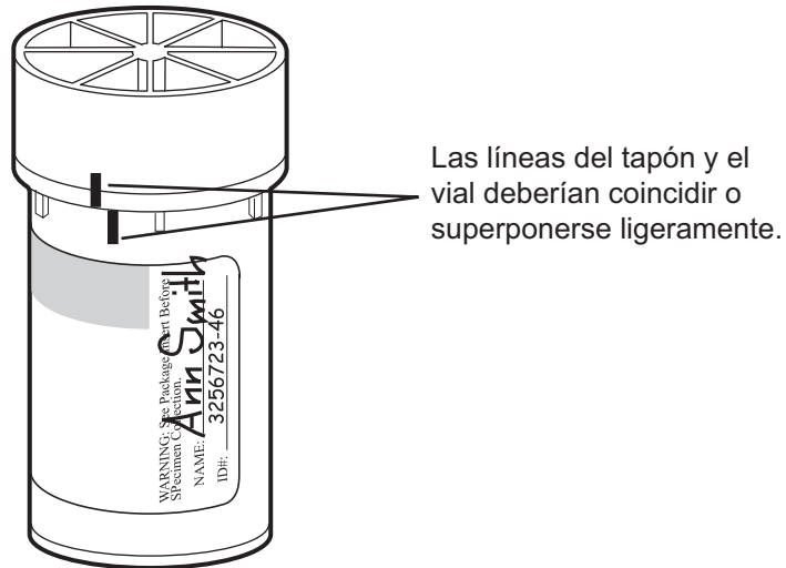
Figura 5A-13 Colocación del tapón en el vial de muestras PreservCyt
