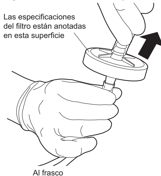
Figura 7-12 Cambio del filtro para residuos
