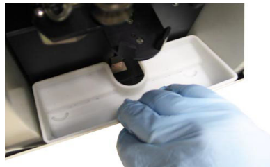
Figura 7-13 Coloque la cubeta de recogida en el habitáculo. Fije los tornillos en las muescas de la cubeta
