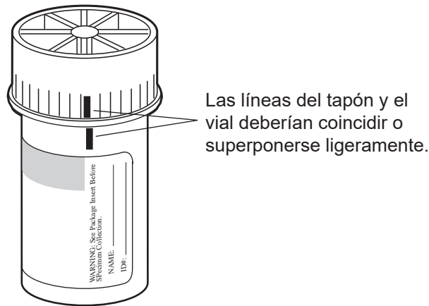
Figura 2-1 Alineación del tapón del vial
