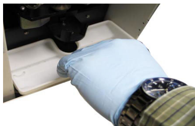
Figura 7-13 Coloque la cubeta de recogida en el habitáculo. Fije los tornillos en las muescas de la cubeta
